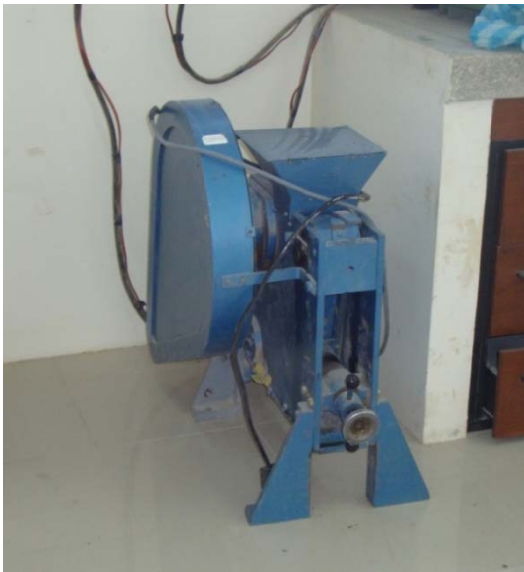
Fotografía N° 28. Trituradora para muestras del laboratorio de suelos de la UTPL.
