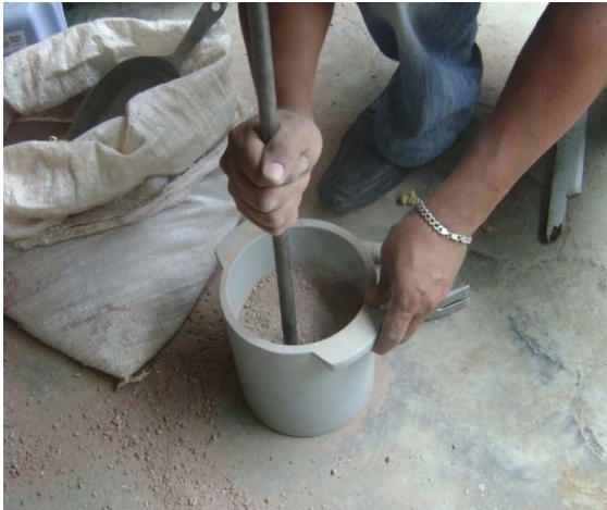
Fotografía N° 48. Compactación del Rcd fino durante el procedimiento para obtener la densidad aparente en estado compactado
