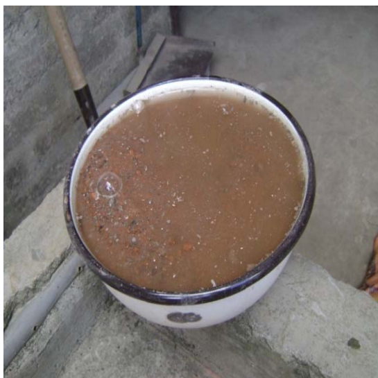
Fotografía N° 36. Árido fino sumergido en agua.
