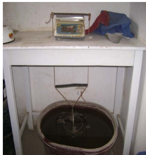
Fotografía N° 46. Registro del peso RCD grueso bajo el agua
