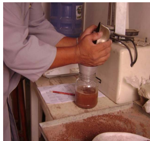
Fotografía N° 40. Colocación de los 500 gr de Rcd en estado saturado superficialmente seco en un frasco con agua.
