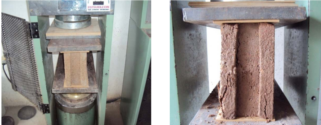
Fotografía N° 60 y 61. Medición de la resistencia de los bloques del ensayo No. 5
