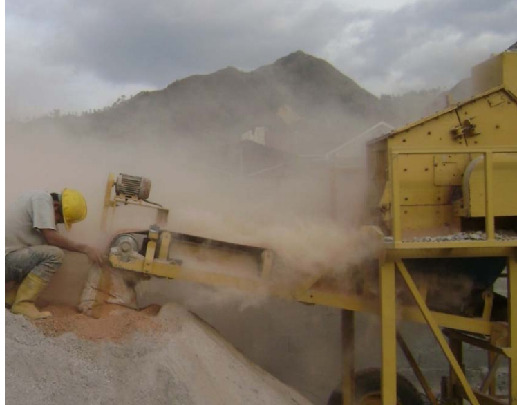
Fotografía Nº 30 Trituradora de la fábrica de bloques usada para nuestro ensayo
