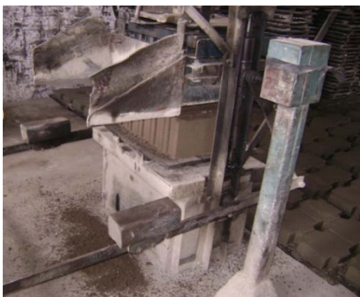
Fotografía N° 57 y 58. Momento en que los bloques salen de la máquina fija de moldeo de bloque
