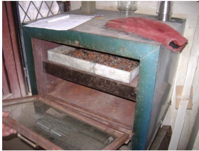
Fotografía Nº 47. Secado de la muestra del RCD en el horno
