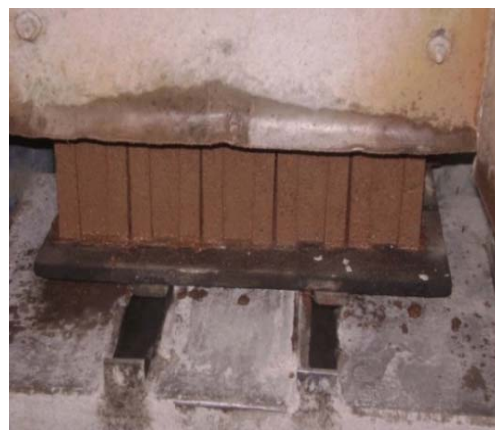
Fotografía N° 57 y 58. Momento en que los bloques salen de la máquina fija de moldeo de bloque
