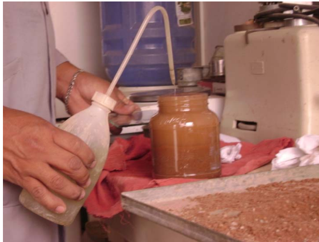
Fotografía N° 41. Proceso listo para la obtención de la densidad real Rcd fino en estado saturado superficialmente seco
