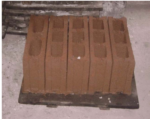
Fotografía Nº 59. Bloques de RCD fuera de la máquina fija de moldeado de bloque
