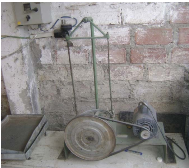
Fotografía N° 34. Tamizadora eléctrica marca SOILTEST
