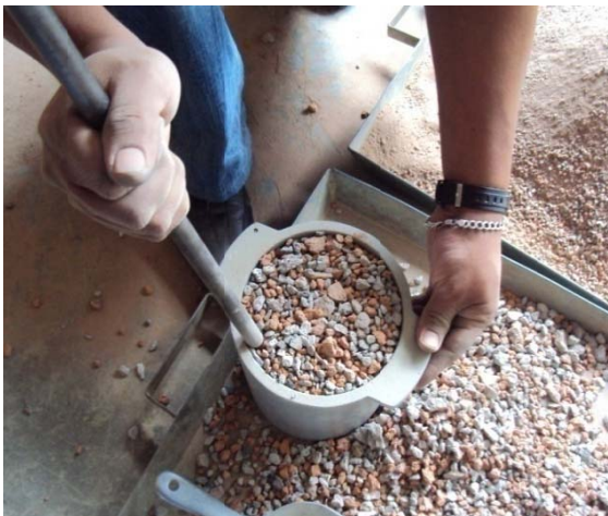
Fotografía N° 50. Compactación del Rcd grueso durante el procedimiento para obtener la densidad aparente en estado compactado
