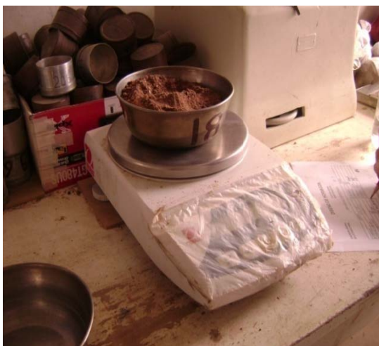
Fotografía N° 39. Registro del peso del Rcd en estado saturado superficialmente seco
