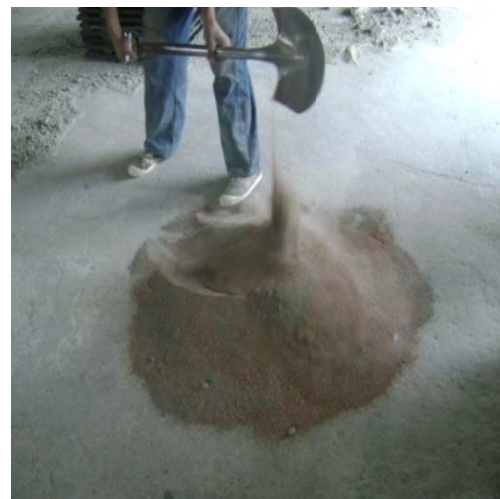
Fotografía N° 52. Homogenización de todos los materiales componentes de los bloques
