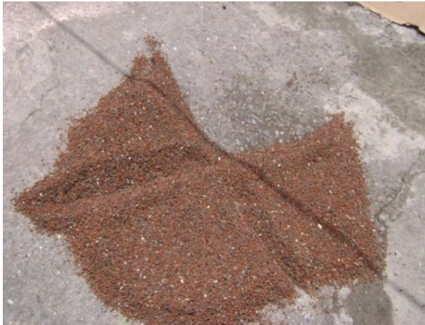
Fotografía N° 32. Cuarteo para la obtención de la muestra.
