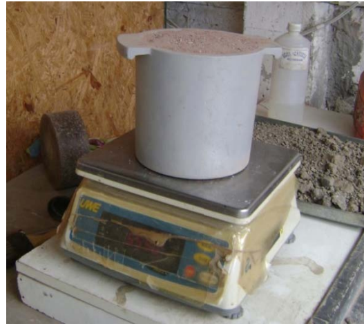
Fotografía N° 49. Registro del peso del árido fino compactado
