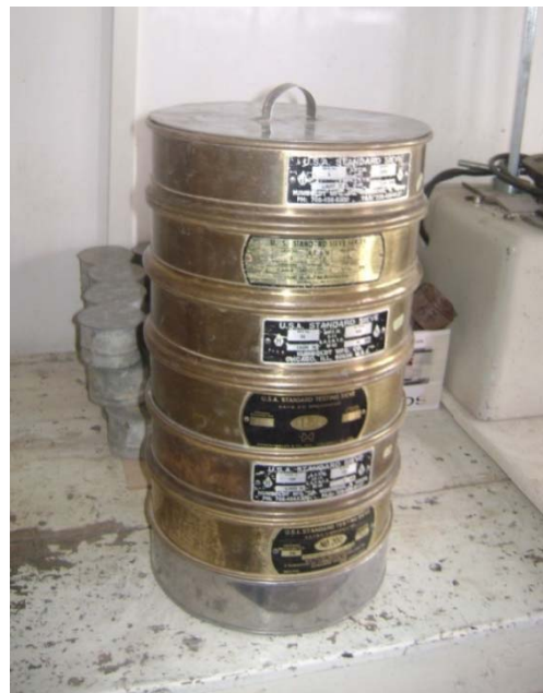
Fotografía N° 33. Tamices usados en la obtención de la granulometría del Rcd fino.
