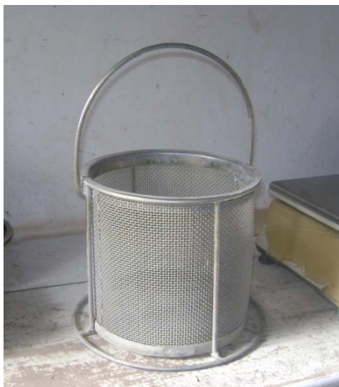
Fotografía N° 45. Canastilla metálica para medir el peso de materiales bajo el agua
