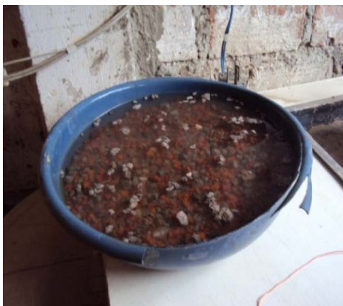
Fotografía N° 42. Árido grueso sumergido en agua.
