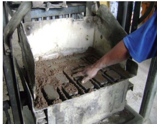
Fotografías N° 55 y 56. Colocación del hormigón en la máquina donde se moldearan los bloques
