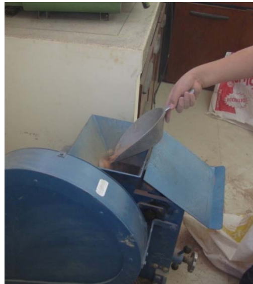
Fotografía N° 29. Momentos en que se llevaba a cabo la trituración del casco de ladrillo.
