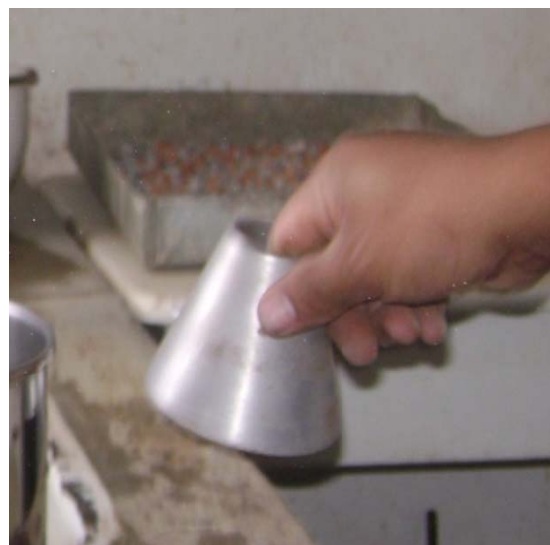
Fotografía N°37. Cono donde se introduce el RCD en estado saturado superficialmente seco
