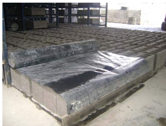
Fotografía N° 25 Curado del bloque.
