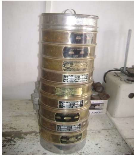
Fotografía Nº 35. Tamices usados en la obtención de la granulometría del árido grueso
