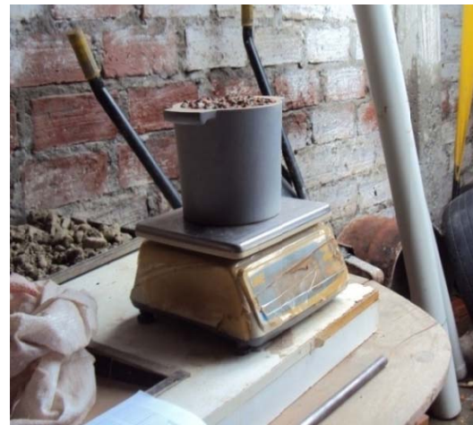
Fotografía N° 51. Registro del peso del árido fino compactado
