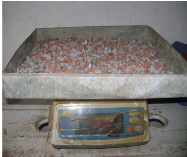
Fotografía N° 44. Registro del peso RCD grueso en estado saturado superficialmente seco
