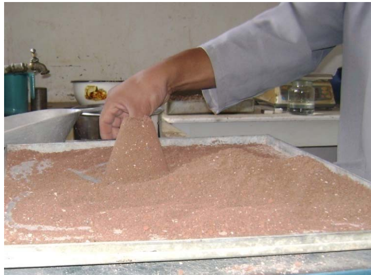
Fotografía N° 38. RCD en estado saturado superficialmente seco
