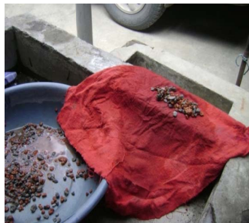
Fotografía N° 43. Árido grueso secado con una franela
