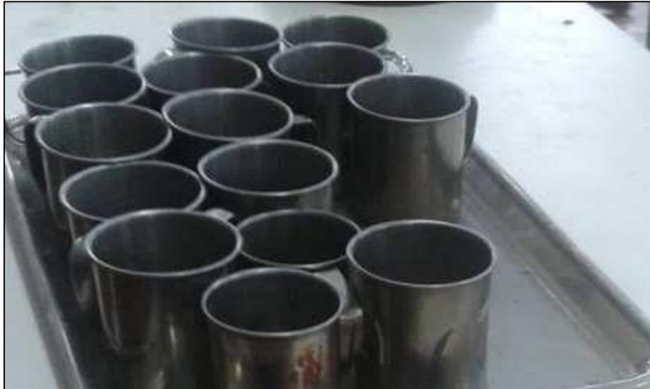
Figura No.3.7 Envases para ensayo de contenido de humedad.
