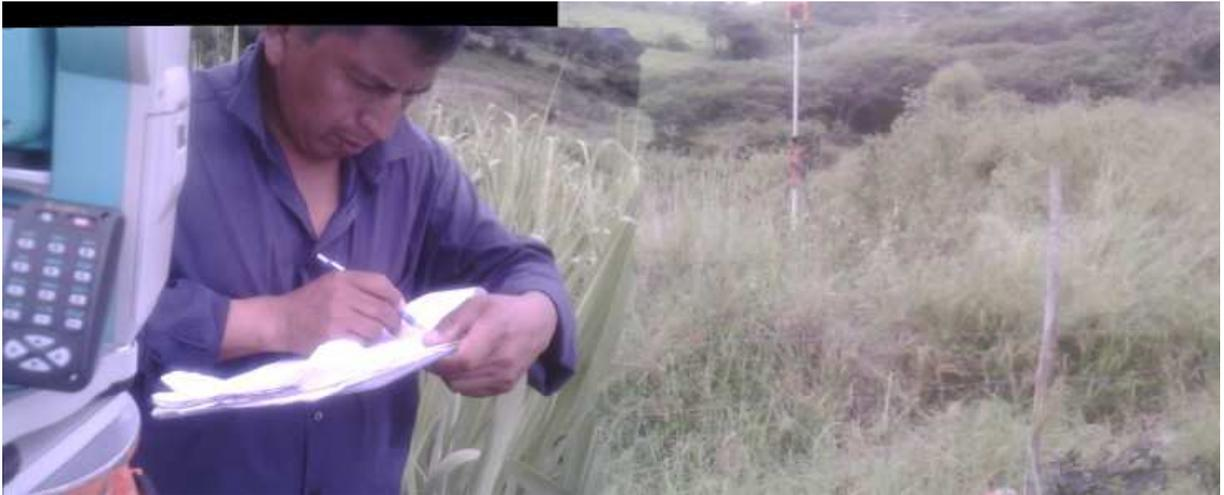
Figura No. 3.1 Levantamiento topográfico con estación total.
