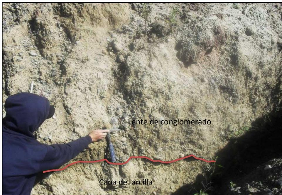
Figura No. 4.3 Afloramiento de conglomerado.
