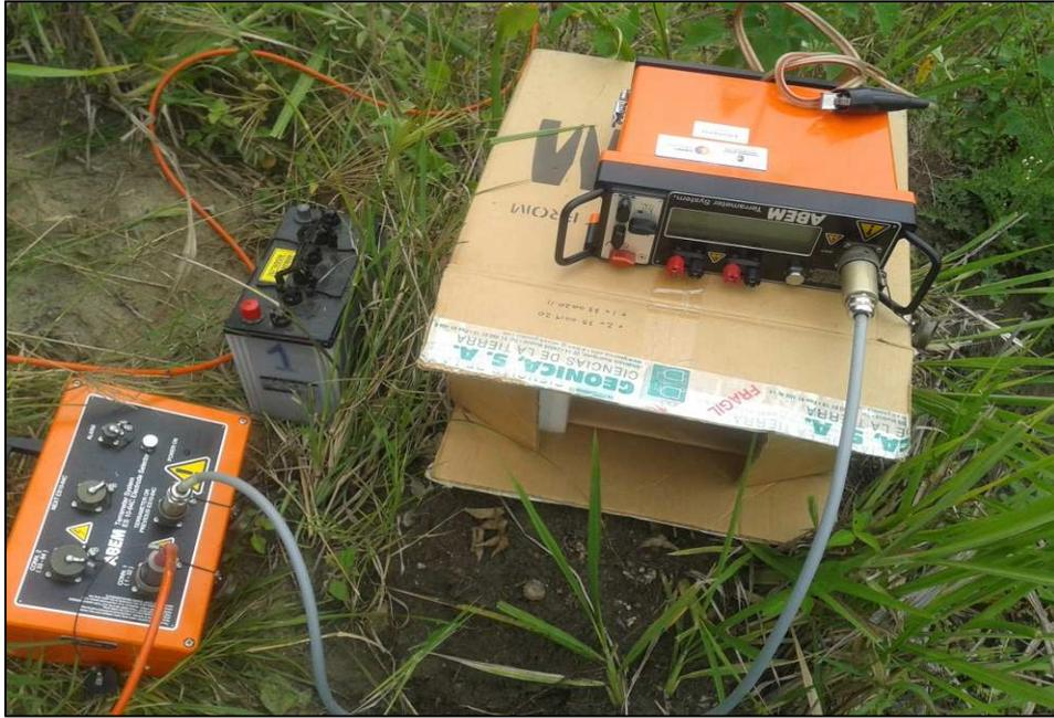
Figura No. 3.4 Equipo de tomografía eléctrica SAS 4000 para mediciones de resistividad eléctrica en suelo.
