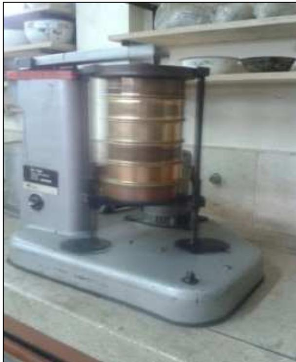
Figura No 3.6 Equipo para ensayo de granulometría.
