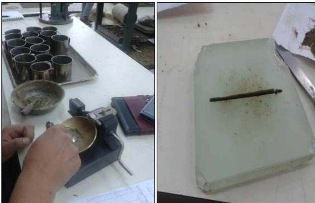
Figura No. 3.8 Ensayo de límites de Atterberg.
