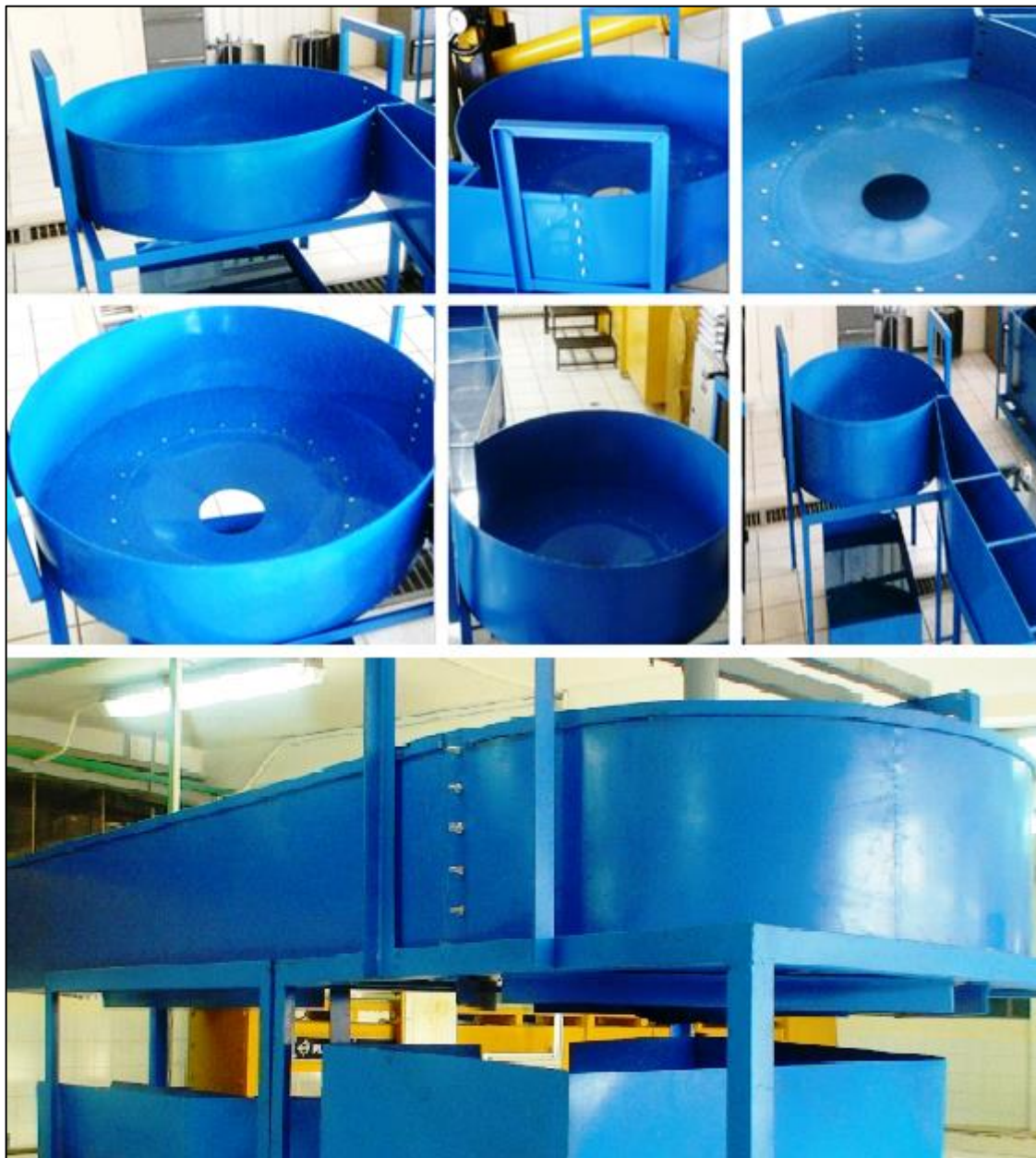
Figura 53. Sistema de vórtice gravitacional para laboratorio
