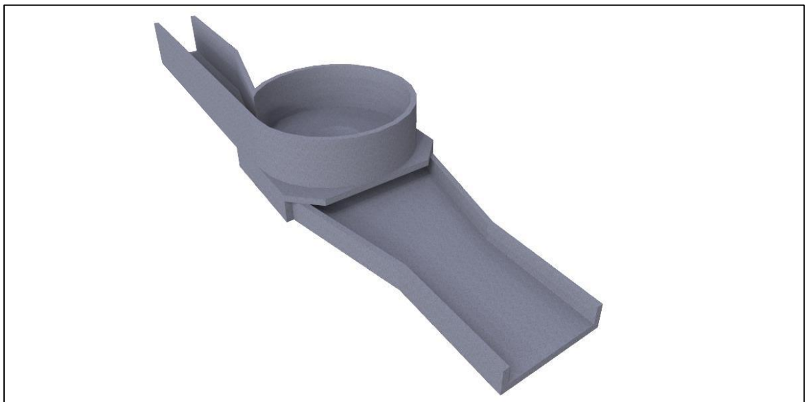
Figura 17. Perspectiva número uno de la vista tridimensional de la estructura hidráulica para la implementación de una micro-central hidroeléctrica basada en vórtice gravitacional
