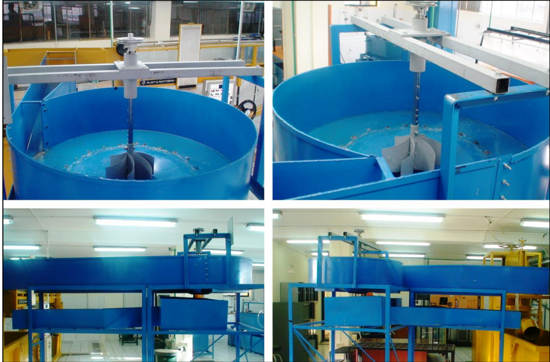
Figura 71. Sistema a escala de vórtice gravitacional implementado en laboratorio
