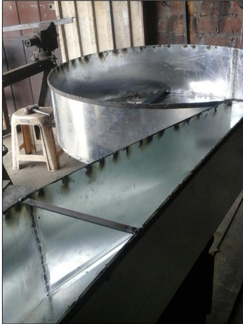
Figura 51. Canal de entrada y tanque de circulación con refuerzo Fuente: Los autores.
