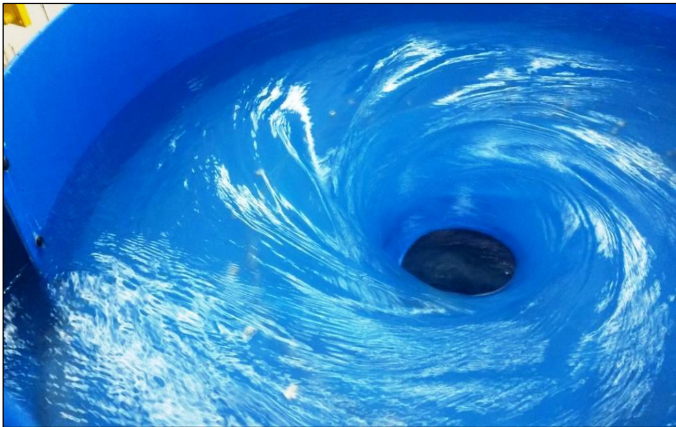
Figura 63. Sistema a escala de vórtice gravitacional en funcionamiento
