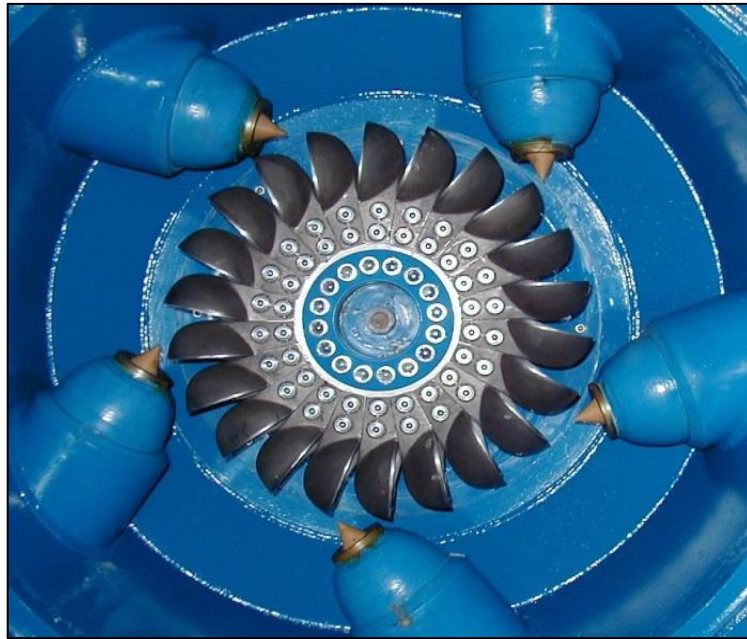
Figura 6. Turbina de acción Pelton
