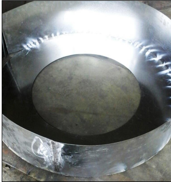
Figura 49. Tanque de circulación con orificio para cono de descarga
