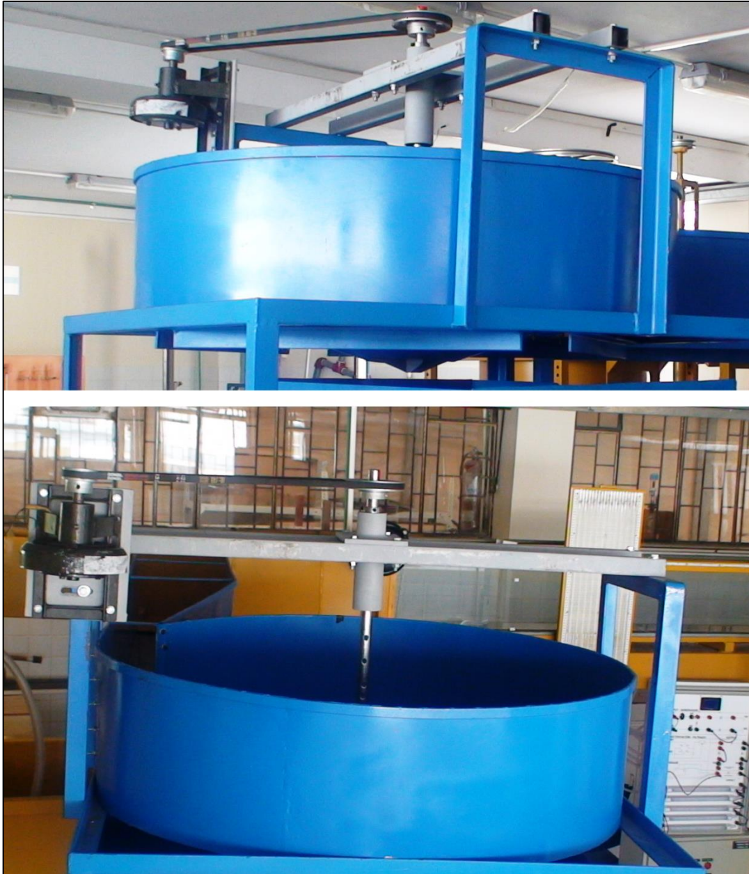
Figura 59. Módulo de transmisión con generador eléctrico
