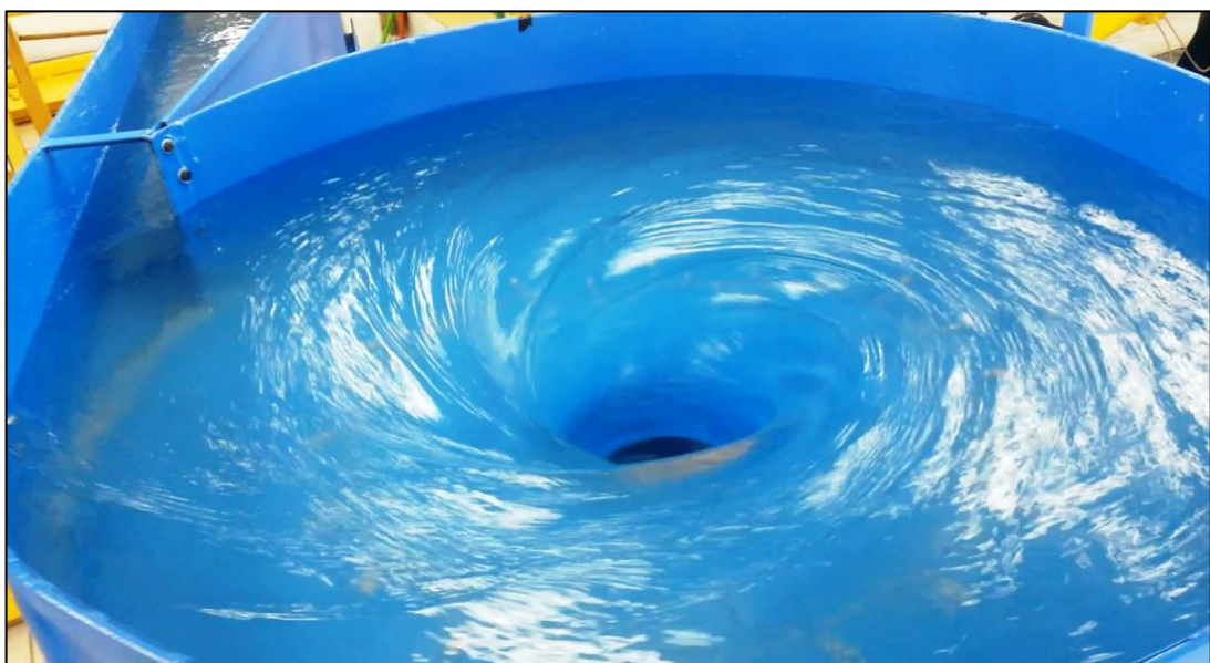
Figura 66. Vórtice gravitacional hidráulico estable
