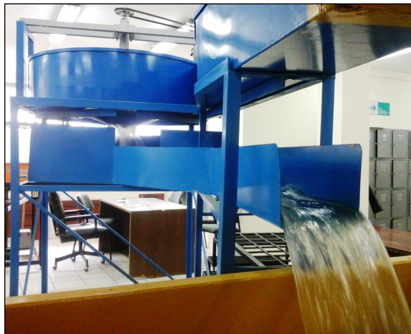
Figura 65. Sistema de recirculación en funcionamiento
