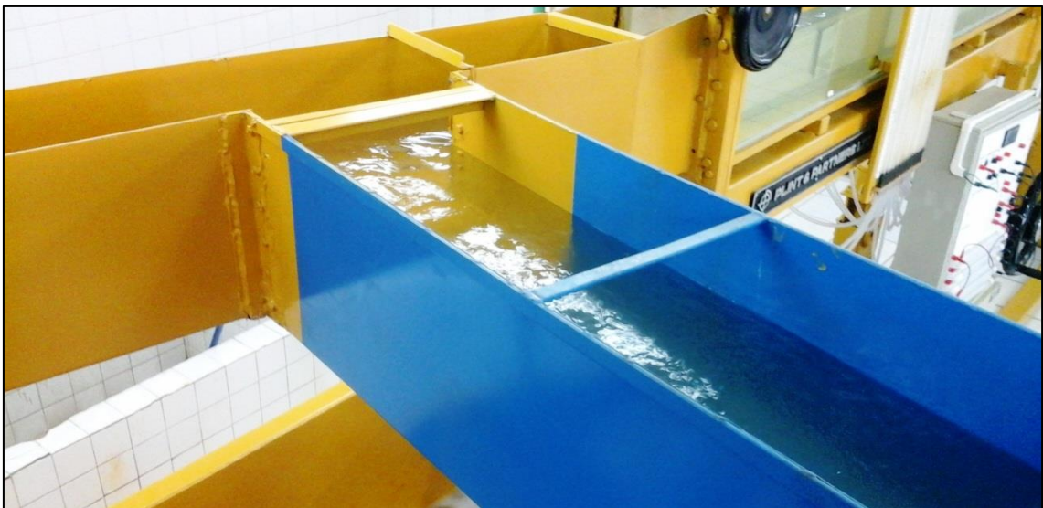
Figura 61. Acople del sistema a escala de vórtice gravitacional en funcionamiento
