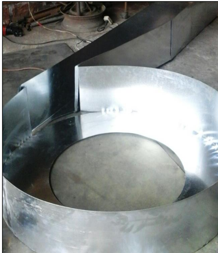
Figura 50. Canal de entrada y tanque de circulación
