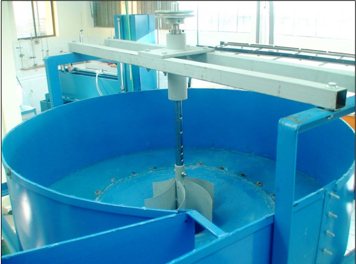
Figura 58. Módulo de transmisión con turbina acoplada
