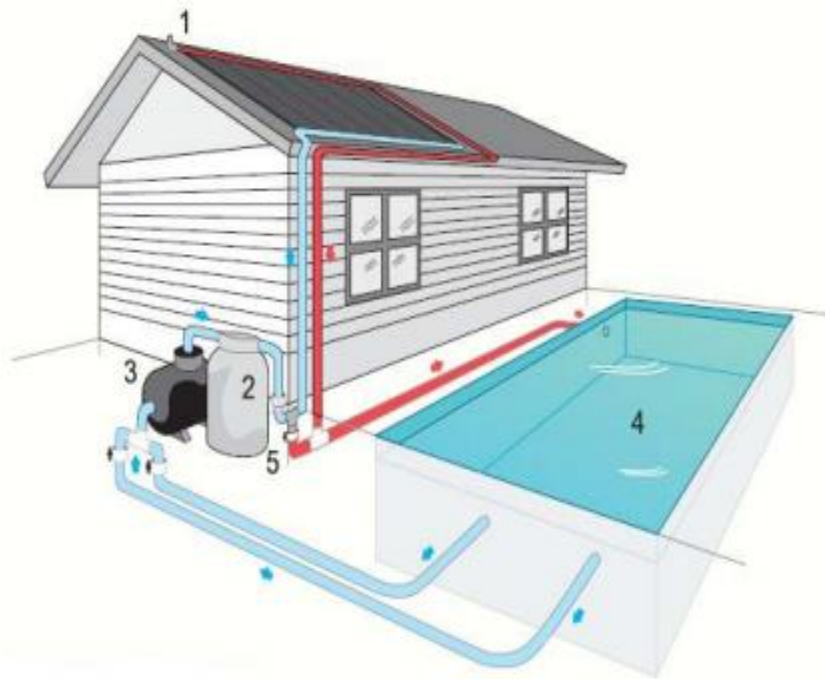
Figura 5.4. Esquema del sistema de calentamiento de la piscina con colector de placa plana sin cubierta. 1 – colector, 2 – filtro, 3 – bomba, 4 – piscina, 5 – llave de bypass.
