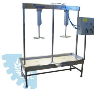
**Mesa de moldeo y desuerado**, para una capacidad de **170 quesos** de 500 gr. cada uno, elaborada en acero inox. AISI-304, montada en una estructura de acero inoxidable AISI 430, la mesa incluye pico para desalojo del suero, regatones de teflón para nivelar al piso, todas las sueldas son en tig y los acabados son totalmente sanitarios.
