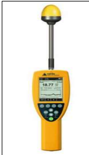
Figura 2.4 Equipo Narda NBM 550 para la medición de RNI.
