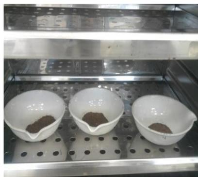
**Figura 2. 3** Cápsulas dentro de estufa
