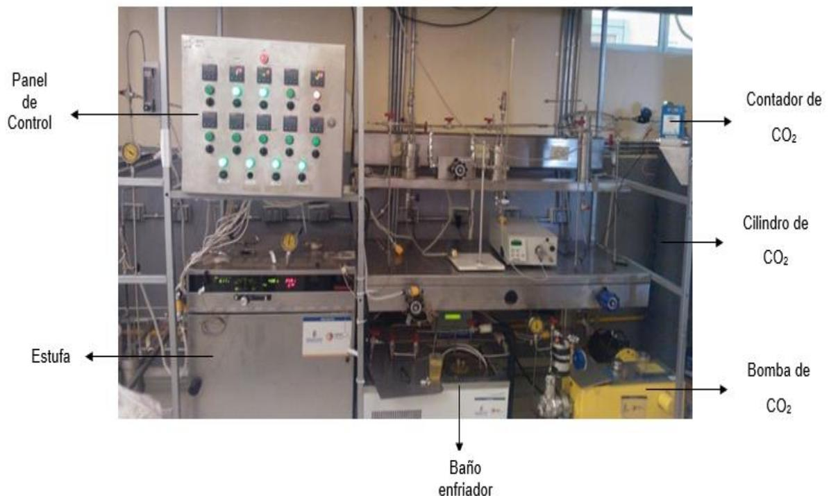
**Figura 2. 7** Fotografía del equipo de fluidos supercríticos.
