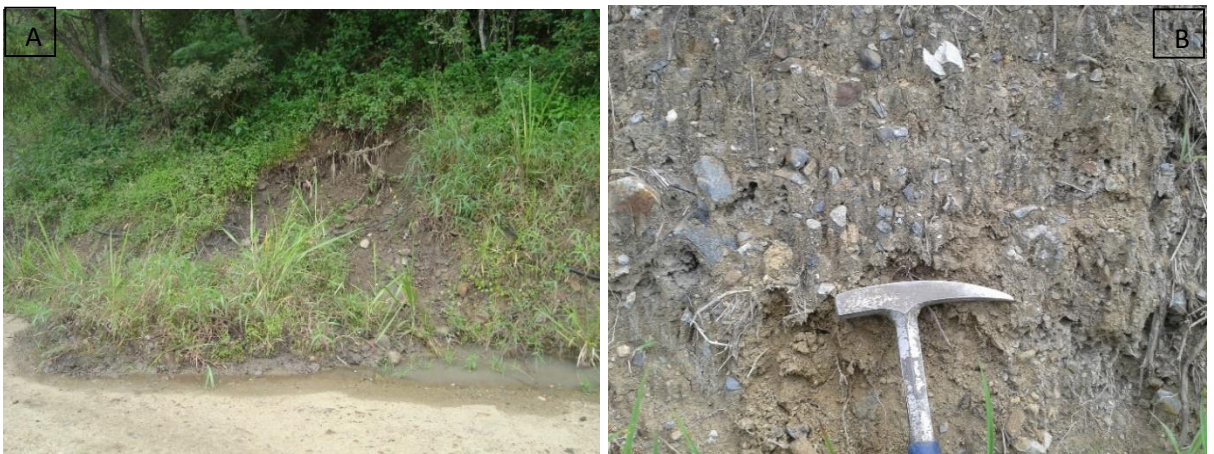
Fotografía 4. 7 Materiales sensibles y colapsables A) Conglomerados saturados de la Fm. Cerro Mandango. B) Material coluvial del MI-13. Fuente: Abarca, 2014.
