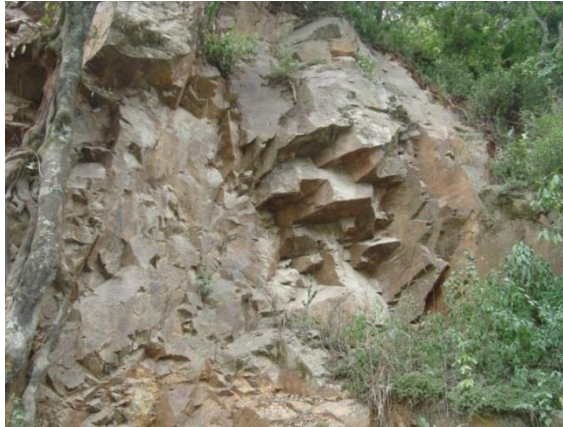
Foto 4. 7 Orientación desfavorable de las discontinuidades, Formación Loma Blanca. Fuente: Carrillo, 2014.
