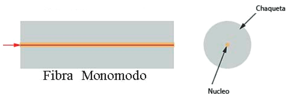
Figura 1.1. Propagación fibra monomodo Fuente: [3]
