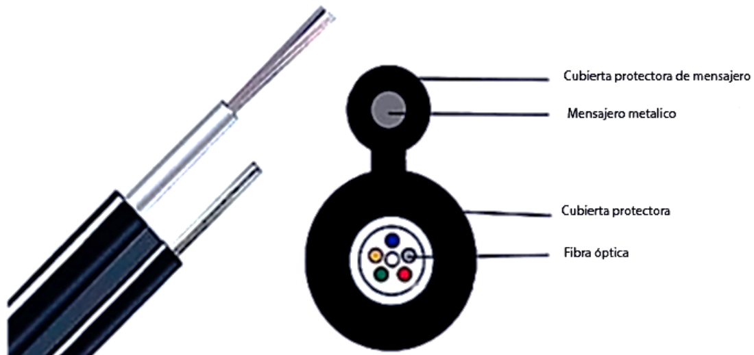
Figura 1.4. Cable figura 8 Fuente: [ http://www.fibraoptica hoy.com/cable-de-fibra-optica-auto-soportado-figura-8/ ]
