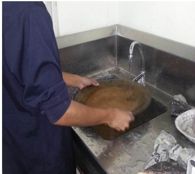
Figura 12. Proceso de deslamado con batea concentradora. Fuente: El Autor.
