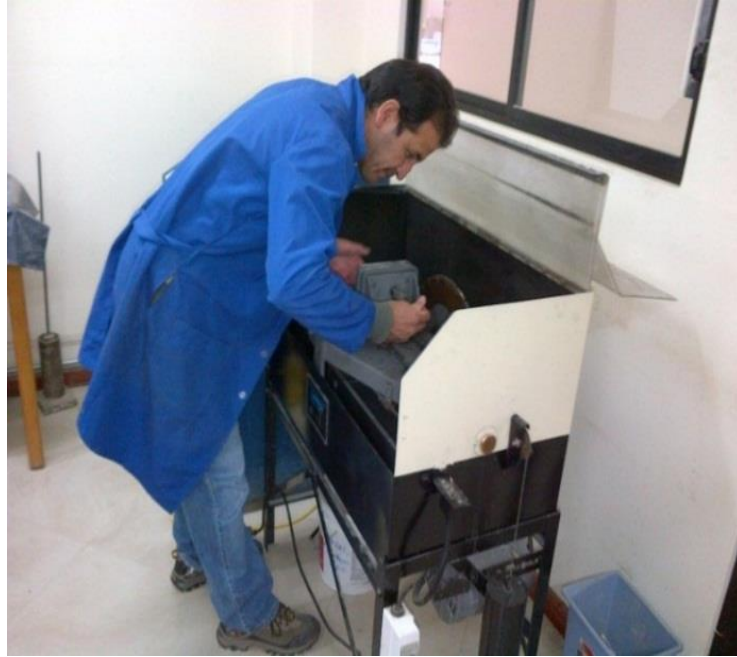
Figura 15. Máquina de corte de rocas ISOMET LAPRO 18 (Laboratorio de Geología y Minas de UTPL). Fuente: El Autor.
