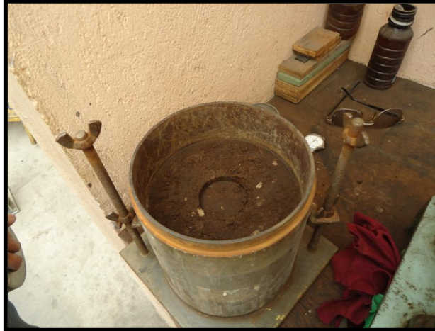
Fotografía 17: Muestra ensayada con el pistón de penetrómetro.
