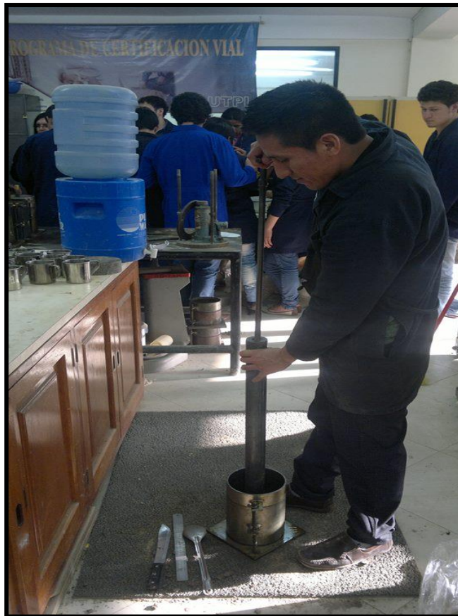
Fotografía 10: Ensayos de compactación.
