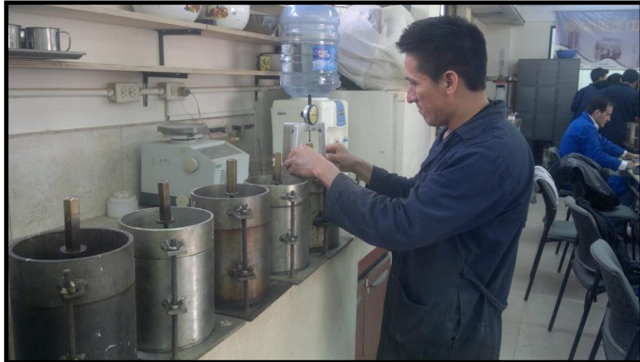
Fotografía 13: Colocación del deformímetro para la toma de lecturas antes de saturar.
