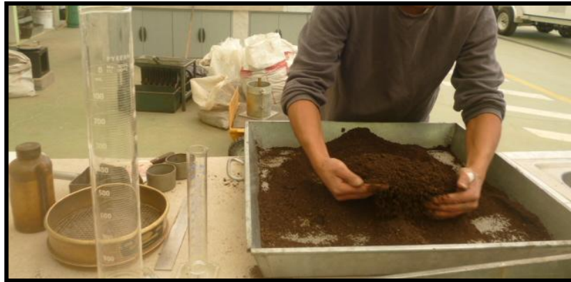
Fotografía 9: Preparación de la muestra para ensayos de compactación y CBR.
