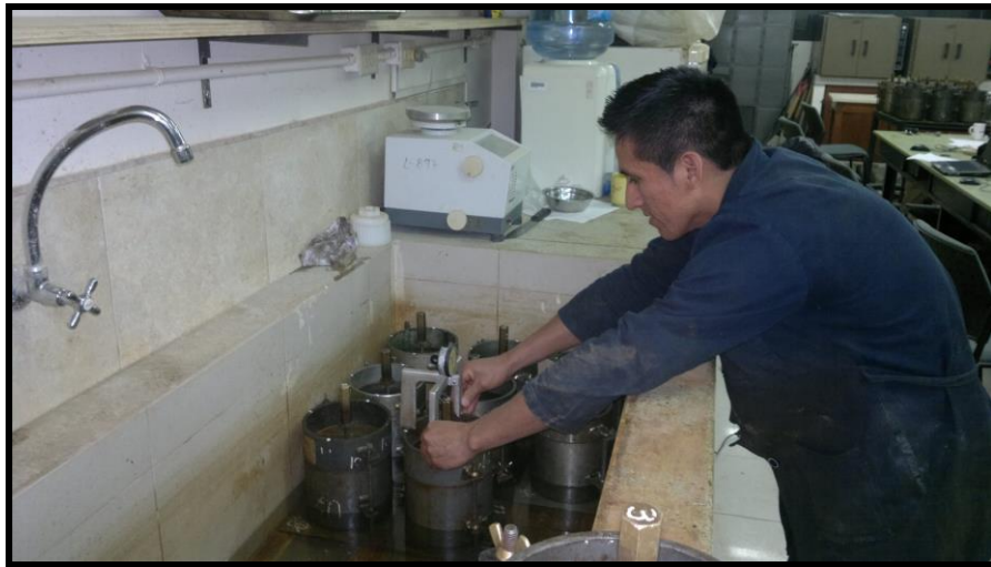
Fotografía 15: Lectura y registro de datos de hinchamiento en las muestra de suelo.
