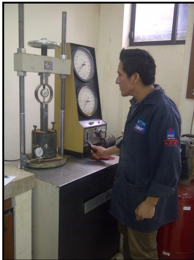
Fotografía 16: Aplicación de la carga sobre el pistón de penetración.
