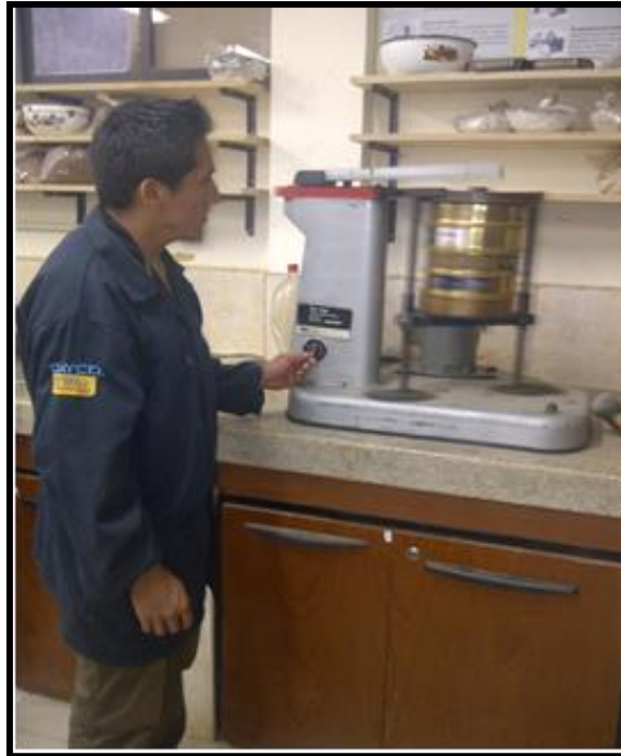
Fotografía 5: Ensayos de granulometría.
