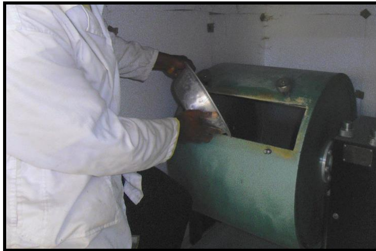
Fotografía 18: Ensayo de abrasión en la máquina de los ángeles.
