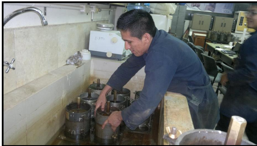
Fotografía 14: Colocación de la muestra de CBR para saturación.
