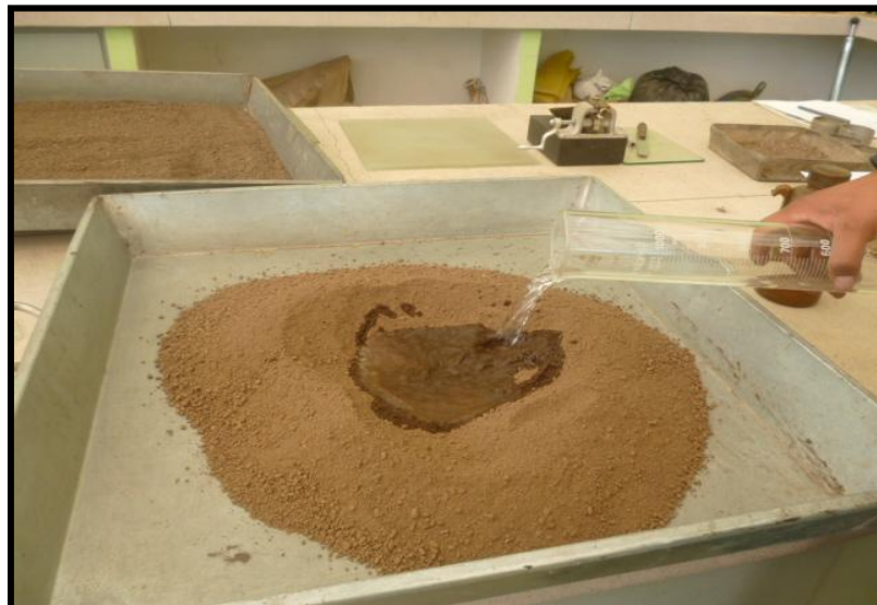
Fotografía 8: Adición de agua, para el ensayo Proctor Modificado.
