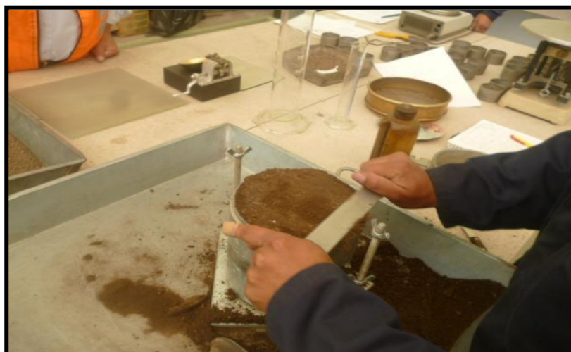
Fotografía 11: Alisado y enrazado de la parte superficial del molde.
