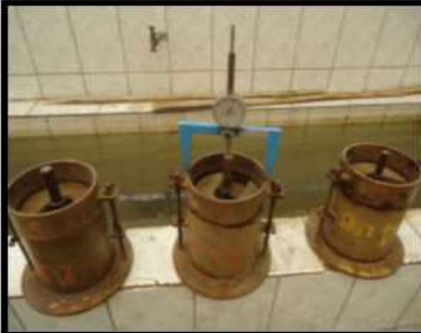
Fotografía 3.23. Lectura y registro de datos de hinchamiento en las muestra de suelo.
