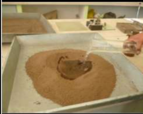
Fotografía 3.17 Adición de agua, para el ensayo Proctor Modificado.
