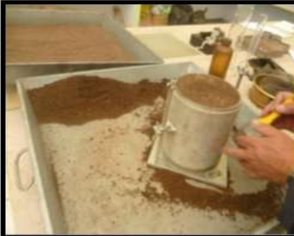
Fotografía 3.21 Colocación del deformímetro para la toma de lecturas antes de remojar las probetas.
