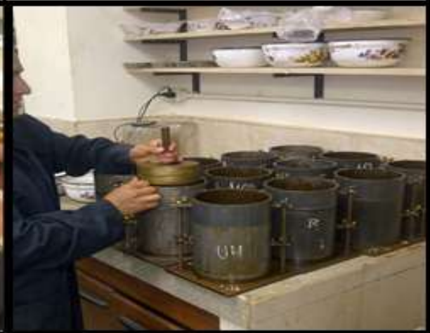
Fotografía 3.20 Colocación de sobrecargas.
