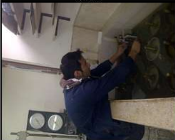
Fotografía 3.23. Lectura y registro de datos de hinchamiento en las muestra de suelo.
