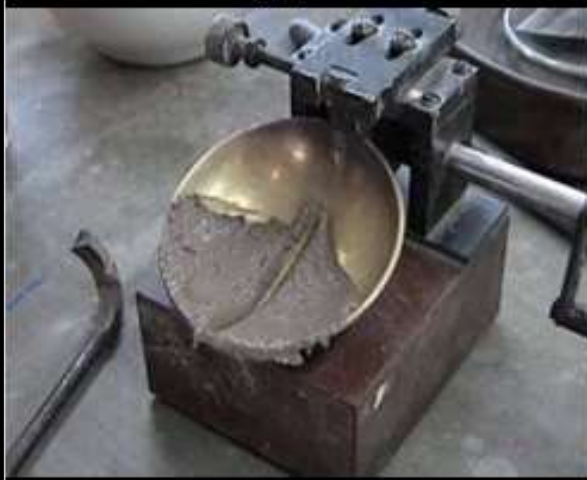
Fotografía 3.7 Muestra con ranura unida a 12 mm luego de la aplicación del No. De golpes
