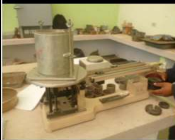
Fotografía 3.17 Adición de agua, para el ensayo Proctor Modificado.
