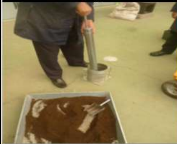
Fotografía 3.13 Caída libre del martillo de 8 Kg. Energía de compactación de 56000 lb/pulg.2
