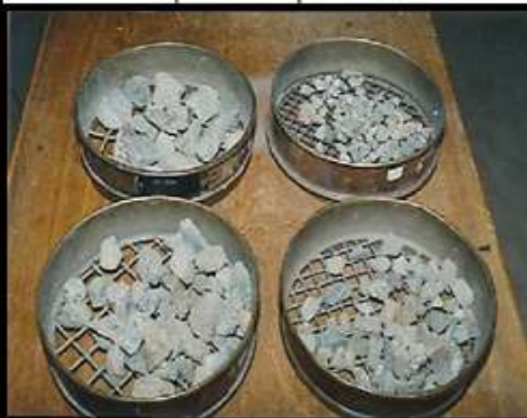
Fotografía 3.26. Peso de los materiales retenidos en las cantidades del método que corresponde.
