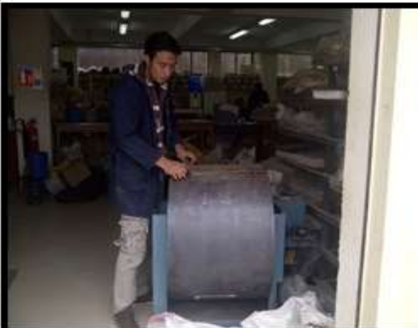
Fotografía 3.27 Colocación del material en la Maquina de los ángeles
