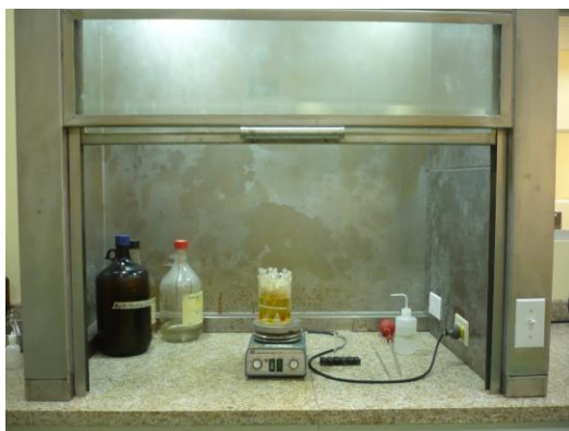
Fotografía 4: Cámara de digestión.
