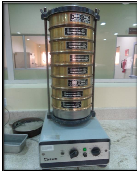
Figura 19. Análisis granulométrico en seco.
