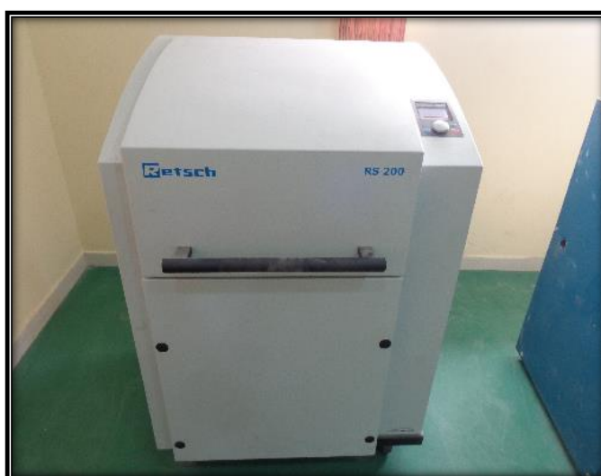
Figura 24. Pulverizadora Retsch RS-200.
