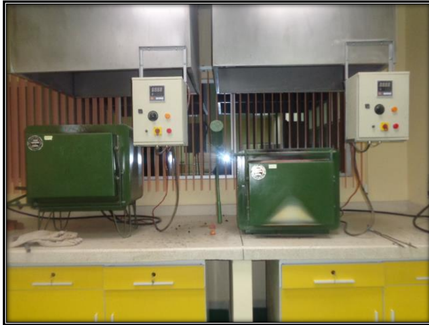
Figura 26. Hornos de Fusión- Copelación.
