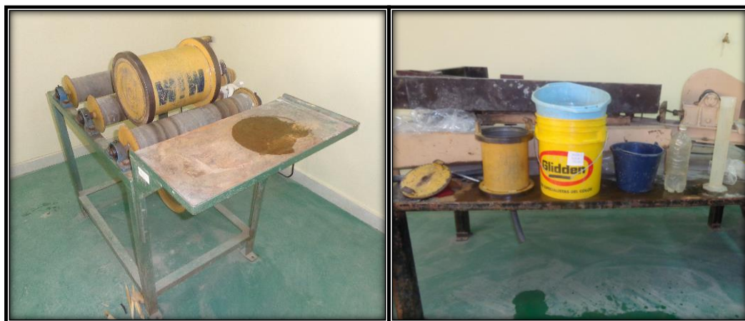
Figura 18. Molino de bolas Batch (Izquierda). Materiales necesarios para la descarga del molino (derecha).
