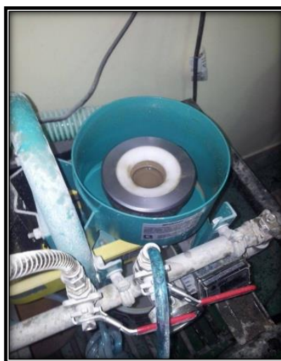
Figura 22. Concentrado en el interior del cono, resultado de la operación gravimétrica.
