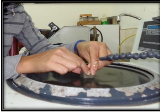
Figura 15. Pulido de las secciones en la pulidora BUEHLER METASERV.
