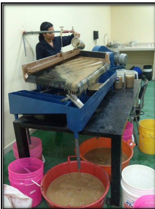
Figura 23. Funcionamiento de la mesa vibratoria.
