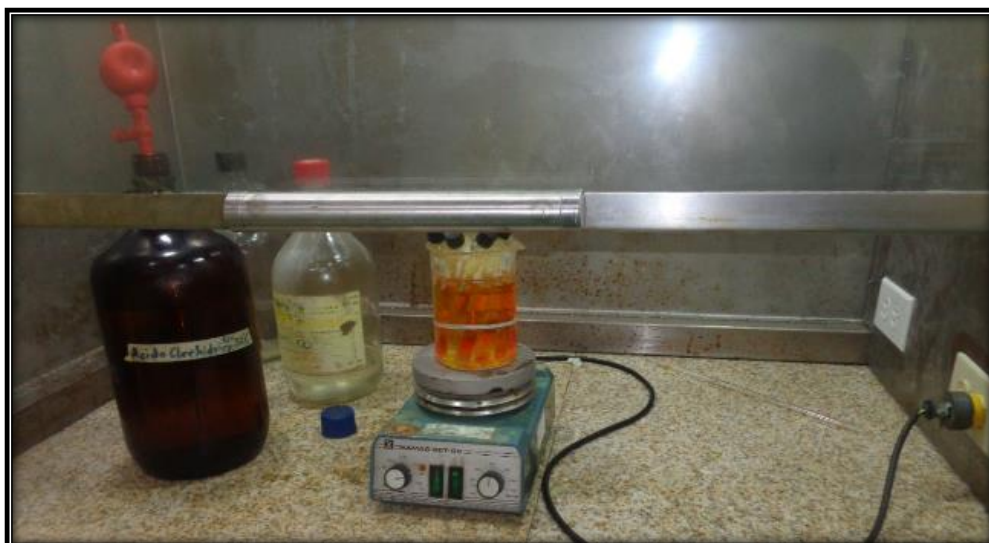
Figura 29. Digestión de muestras con agua regia.
