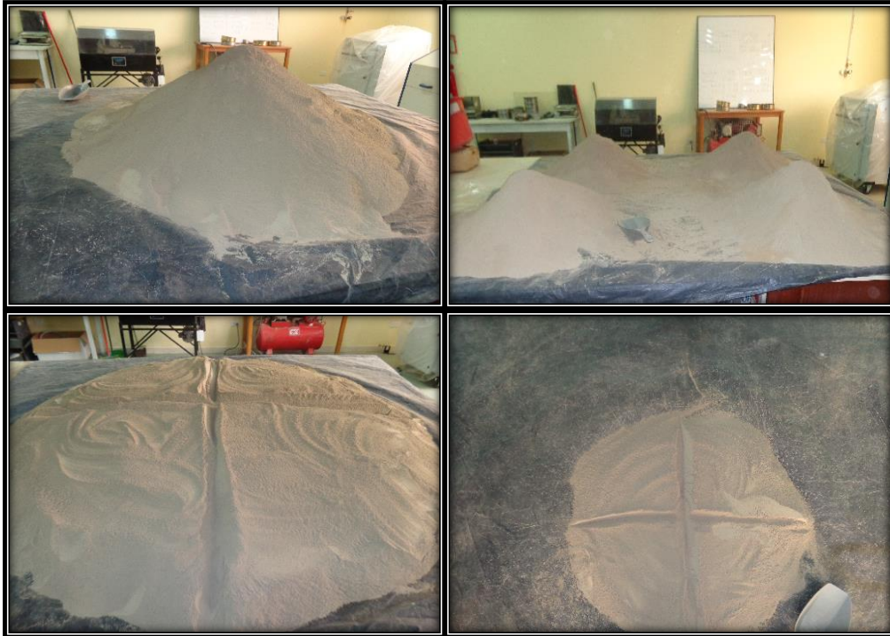
Figura 11. Homogenización (Figura superior) y cuarteo del material (Figura inferior).
