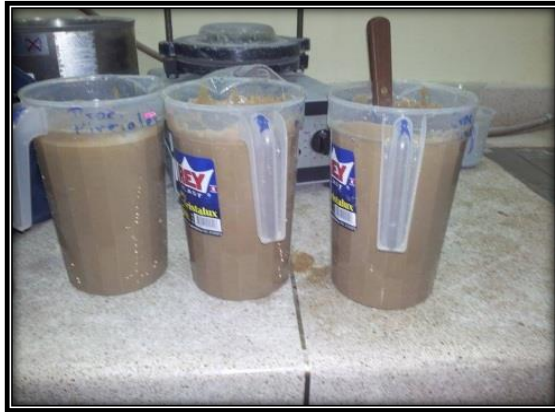
Figura 20. Material en forma de pulpa para la alimentación del concentrador.
