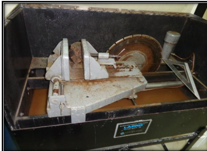
Figura 14. Cortadora de rocas BUEHLER LAPRO 18.
