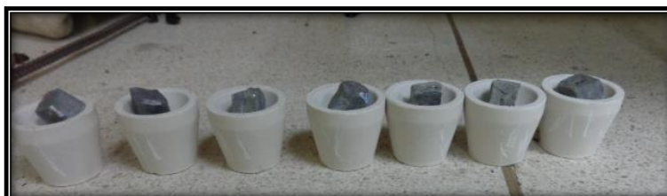
Figura 28. Muestras listas en cada una de las copelas para introducirlas al equipo.
