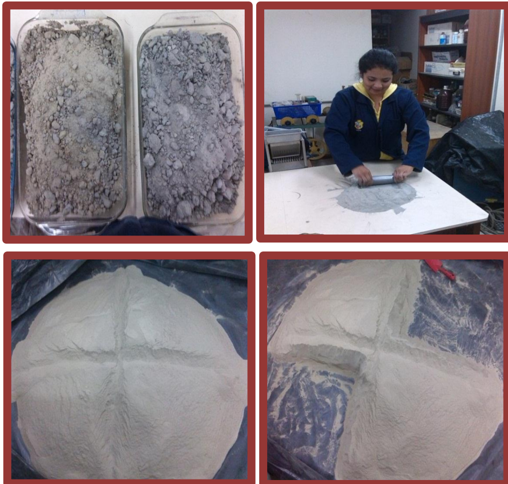
Foto N° 3. Proceso de Disgregación, Homogenización y Cuarteo de la muestra.
