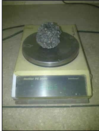
Figura 32: Briqueta luego de someterla al ensayo de cántabro.
