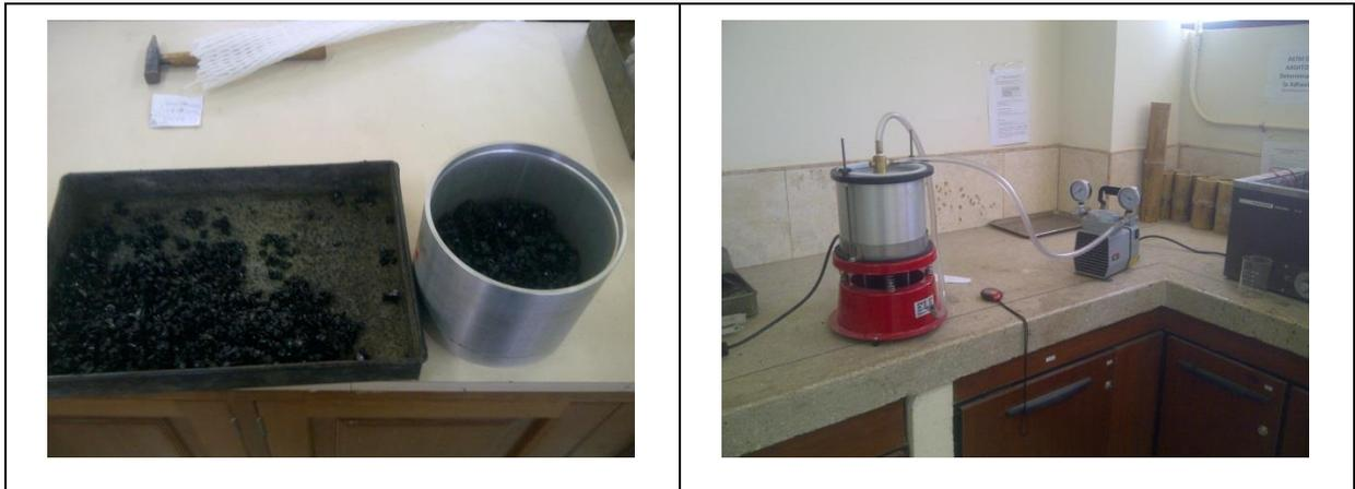
Figura 31: Ensayo Densidad Rice para obtener la densidad Bulk.
