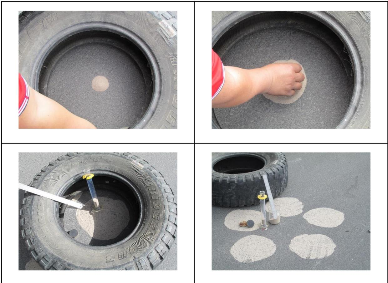
Figura: 37. Ensayo del círculo de arena en campo.
