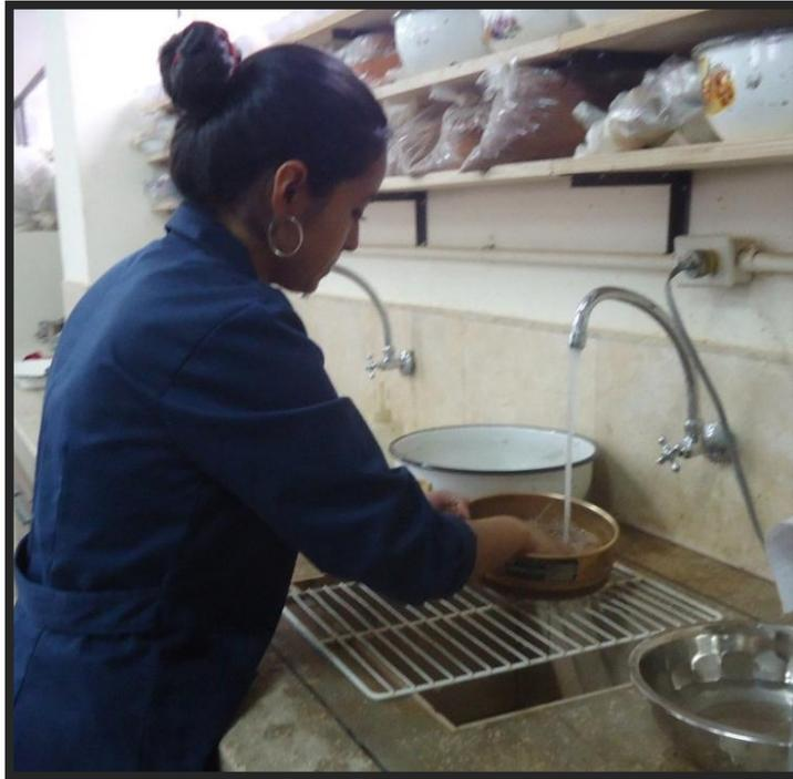
Imagen 7: Lavado de la muestra, utilizando el tamiz N° 200.
