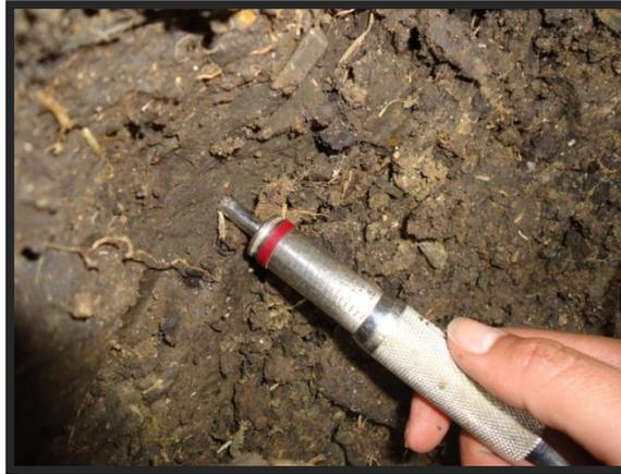
Imagen 3: Ensayo de penetrómetro de bolsillo.
