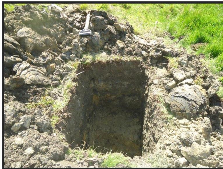
Imagen 4: Excavación manual para la obtención de muestras.
