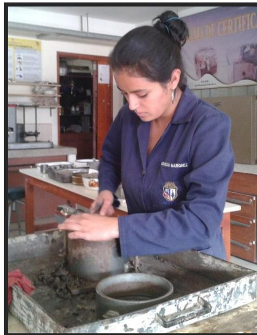
Imagen 15: Enrasado de la muestra después de compactada.
