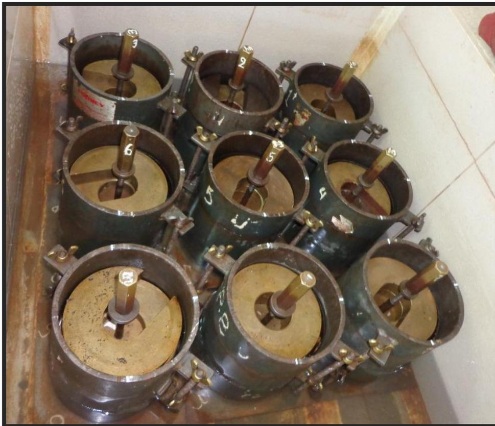
Imagen 16: Inmersión de las probetas.
