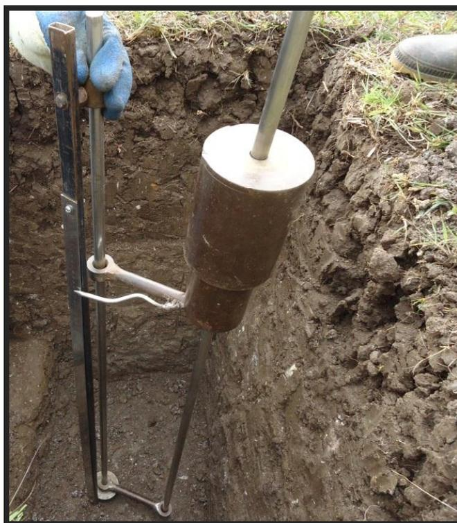
Imagen 2: Ejecución del ensayo DCP.
