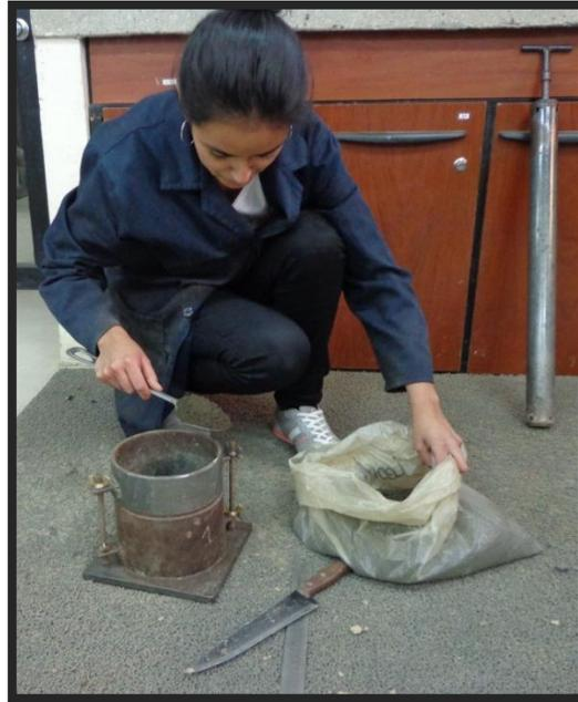
Imagen 14: Ensayo de compactación, colocación de la muestra en el cilindro.
