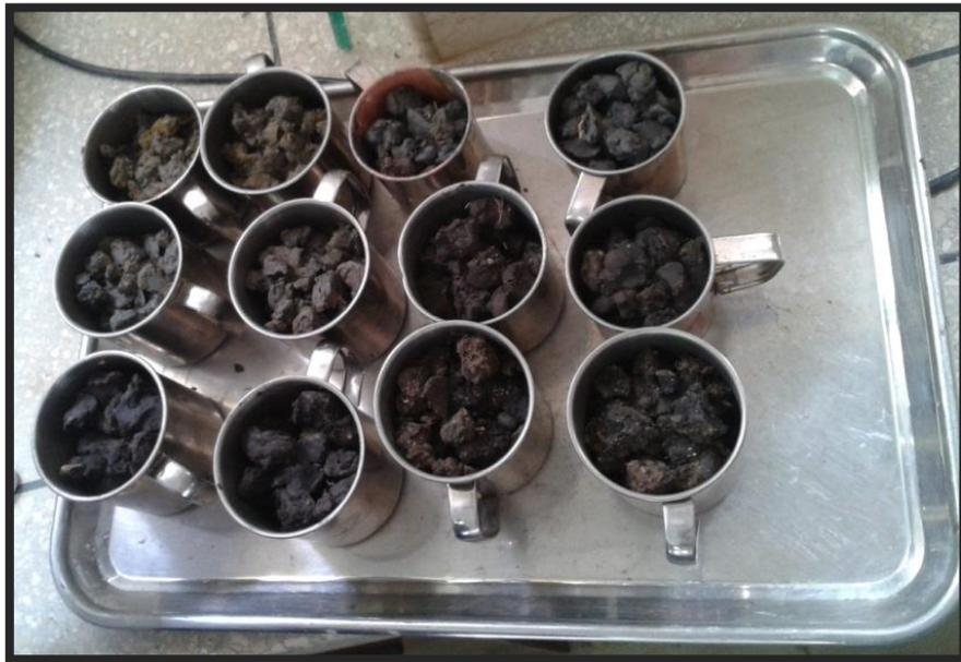
Imagen 5: Muestra para determinar el contenido de humedad.
