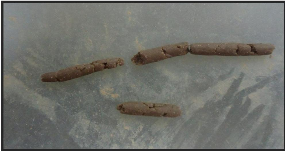
Imagen 13: Cilindro agrietado, de 3 mm de diámetro aproximadamente.
