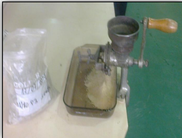
Trituración de la muestra con ayuda de un molino doméstico
