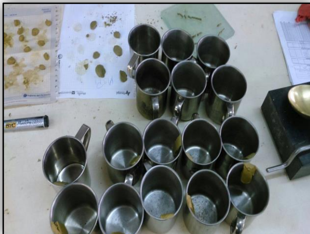
Muestras sacadas del horno, luego de ensayos de Límite Líquido y Plástico.
