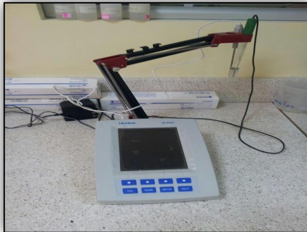
Equipo de medición de pH. Peachímetro.
