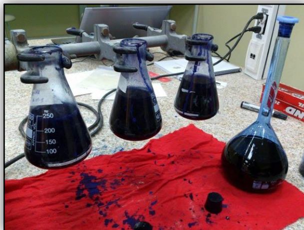
Matraces montados en agitador, en el ensayo de azul de metileno.
