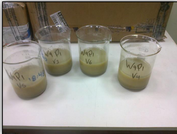
Separación de arcillas y limos por decantación
