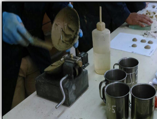
Colocación de muestra en el equipo de Casagrande para determinar Límite Líquido.
