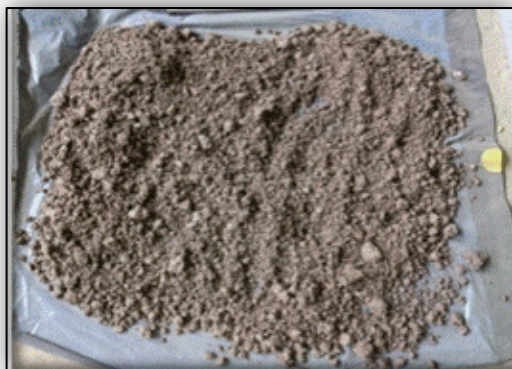
Figura 9. Secado y triturado de las muestras Fuente: Díaz, W.
