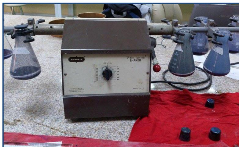
**Figura 14.** Agitador de muñeca con velocidad regulable.
