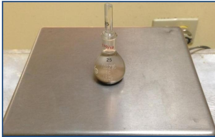
**Figura 13.** Picnómetro para determinar la densidad.
