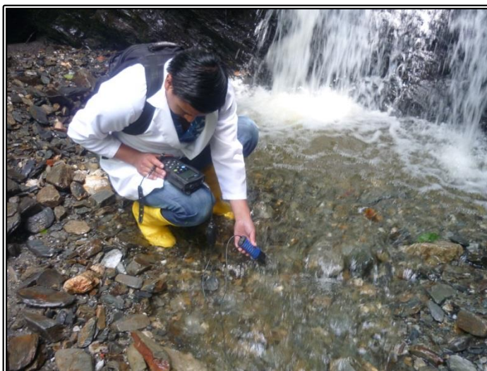
Figura 14. Medición in situ de ph, temperatura, oxígeno disuelto, porcentaje de saturación y humedad relativa. Fuente: El autor
