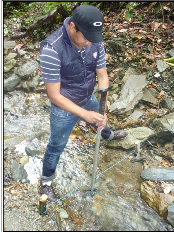
Figura 13. Aforo con molinete. Fuente: El autor
