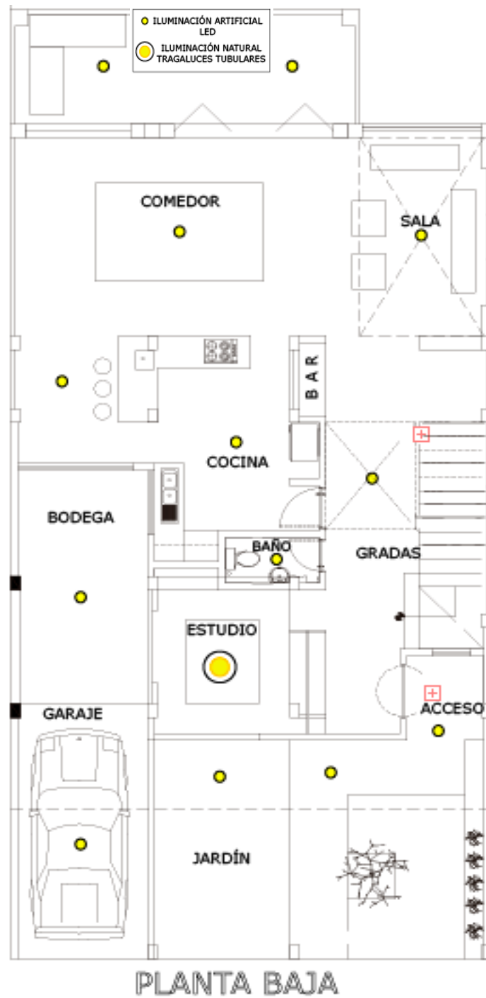
Figura 2.18 Distribución de iluminarias LED y tragaluces tubulares solares en la planta baja de la vivienda urbana tipo.
