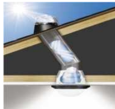
Fig.3. Esquema de un tragaluz tubular solar. Esquema tomada [online] de http://ecoinventos.com/wp-content/uploads/2011/12/tragaluz-tubular-a-led-3270-3768735.jpg
