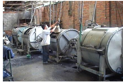
Los pantalones están siendo sometidos al proceso, adicionando más químicos al lavado.
