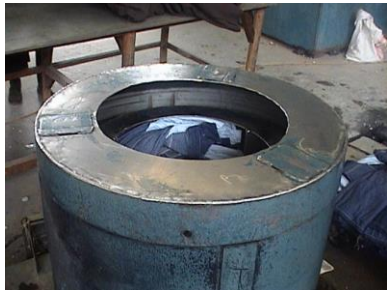
Luego de lavados los pantalones, son llevados a una máquina exprimidora, para eliminar la mayor cantidad de agua en los pantalones.
