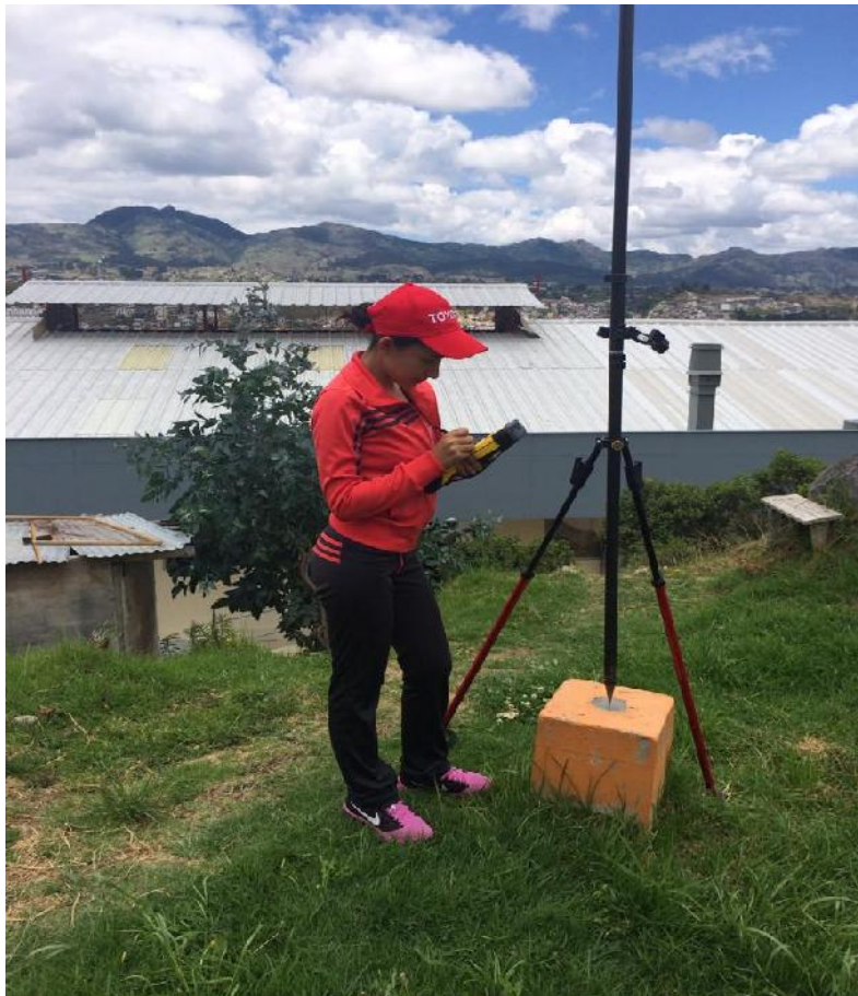
Fotografía 6. Programación de equipo TRIMBLE R6 en la Estación LJEC-1
