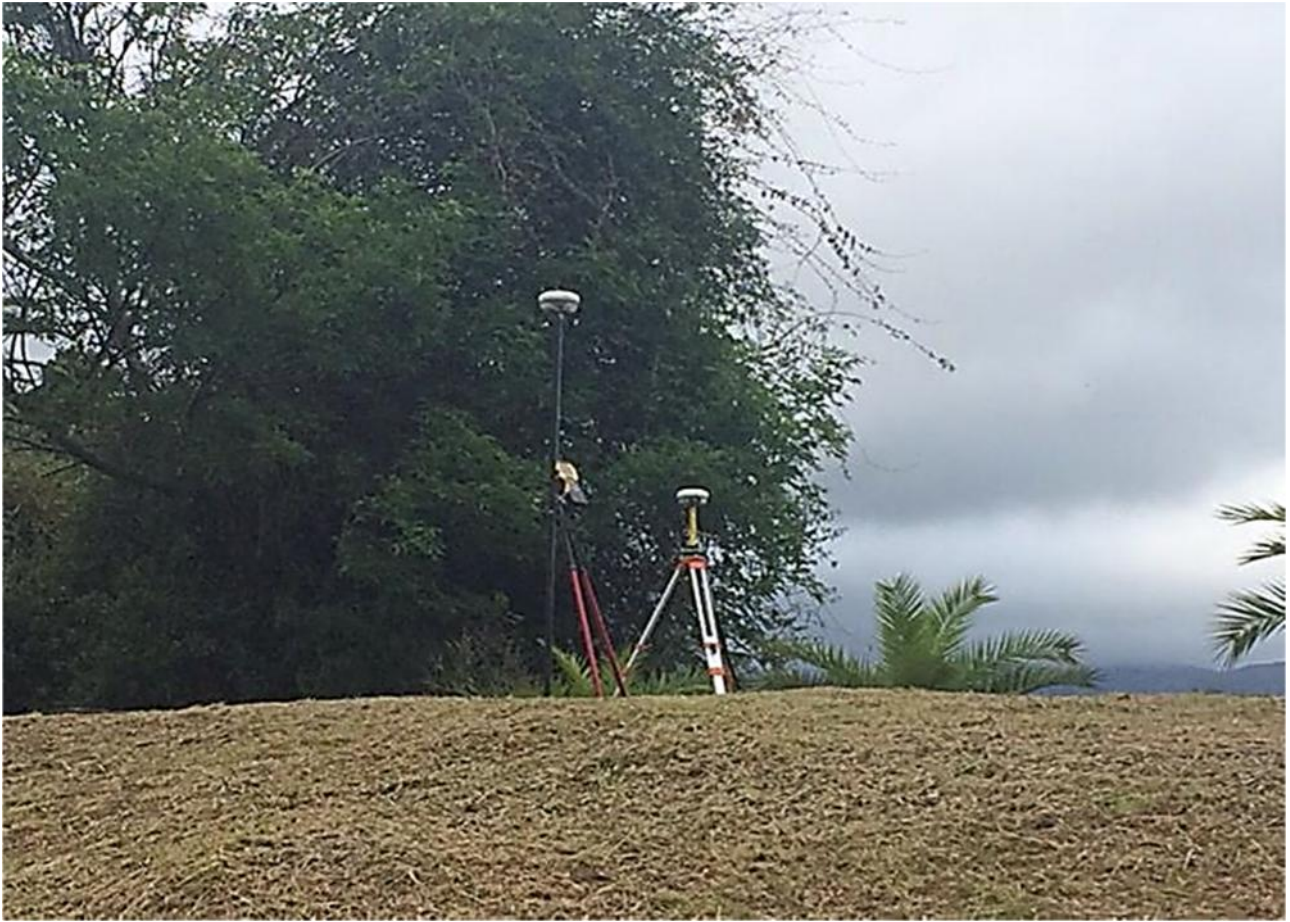
Fotografía 7. Equipo TRIMBLE R6 (Base-Receptor) en la Estación LJEC-3
