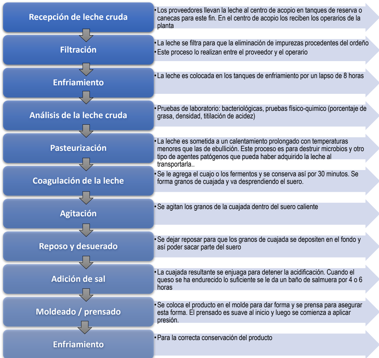
Figura 7. Proceso de fabricación del queso fresco Elaborado por: la autora
