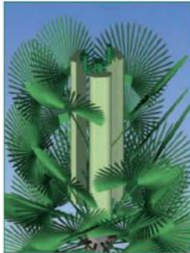
Figura 0.4 Montaje de equipos en copa torres estilo palmera. Fuente: [1]
