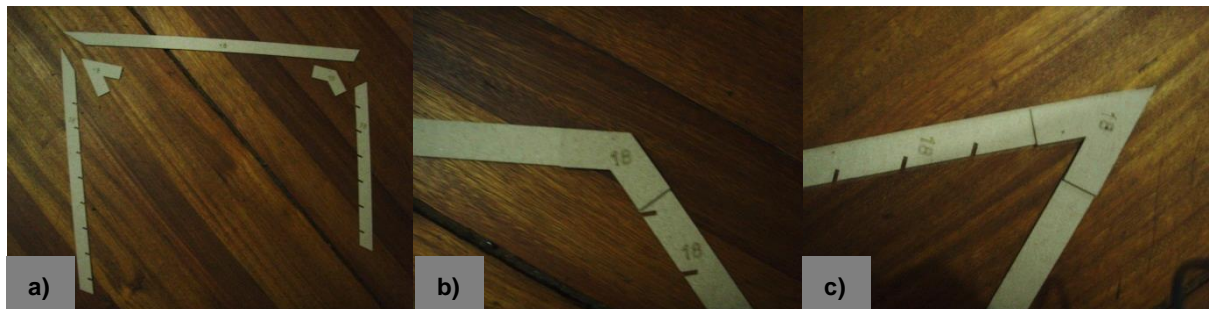
Imagen 4-13. Armado de pórticos mediante placas hechas del mismo material.
