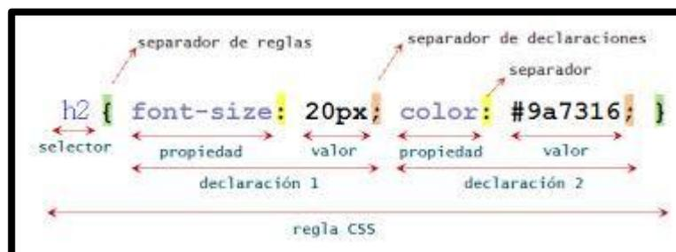
Figura 1.13. [La siguiente imagen muestra la utilización de una regla dentro de un CSS].
