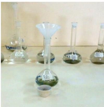
Fotografía 13. Disolución de las cenizas para determinación de Potasio.
