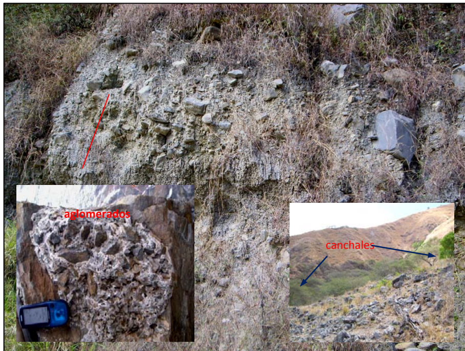
Foto No. 17: Depósitos Coluviales de esquistos verdes y cuarcitas con algunos aglomerados sostenidos en una matriz limo-arcillosa, otros formando canchales
