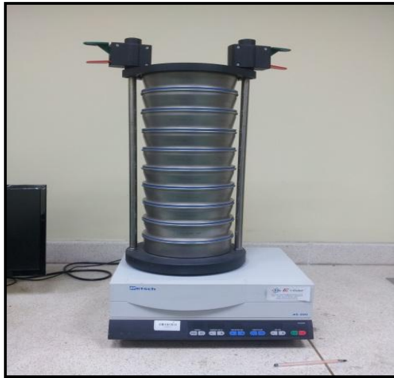
Imagen 11. Análisis granulométrico por vía seca Fuente: Romero, 2015.
