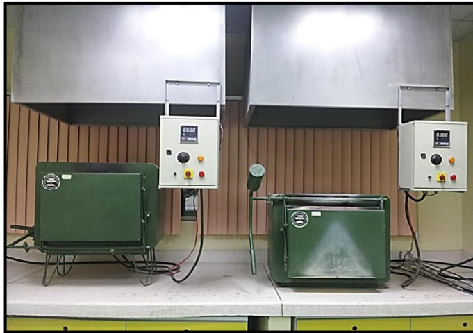
Imagen 15. Mufla de fusión izquierda y mufla de copelación derecha. Fuente: Romero, 2015.
