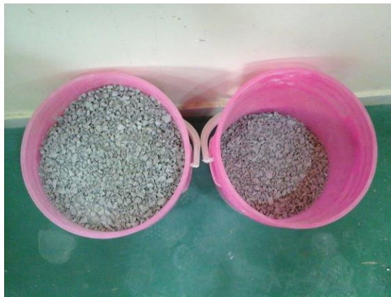
Imagen 4. Material que pasa el tamiz # 10 Fuente: Marcheno, 2015.
