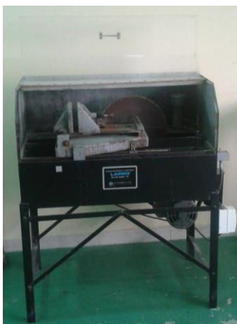
Imagen 11-1. Máquina de corte de rocas de disco adiamantado.
