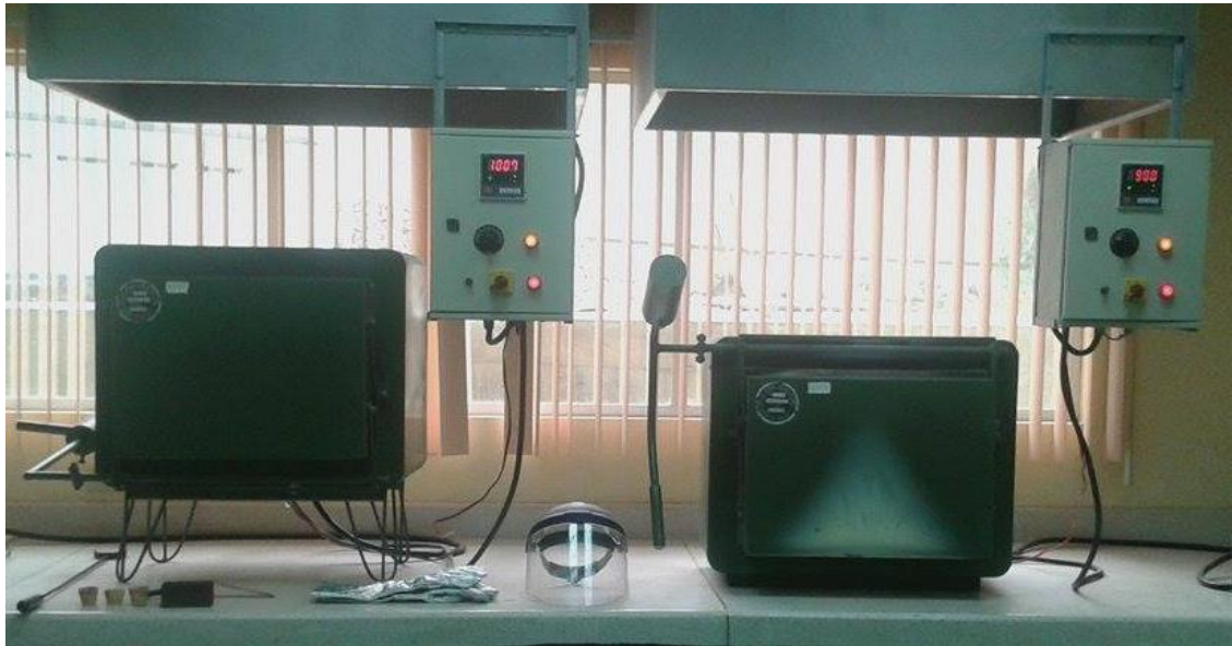
Imagen 13. Muflas de Fisión (Izquierda) Y Copelación (Derecha) Fuente: Marcheno, 2015.
