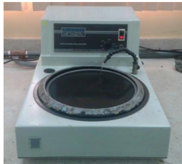
Imagen 10-2. Máquina de lijado de marca METASRV
