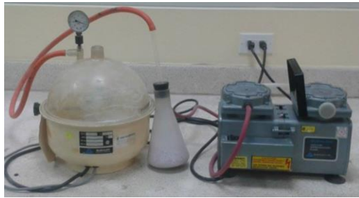
Imagen 10-1. Cámara al vacío de marca BUEHLER.
