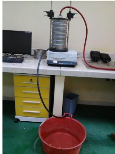
Imagen 8. Ensayo Granulométrico. Código de muestra: CS-N Fuente: Marcheno, 2015.
