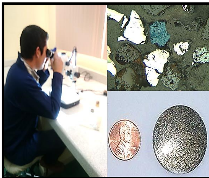
Foto N° 10. Análisis de Sección Pulida. Fuente: Espinosa, 2015
