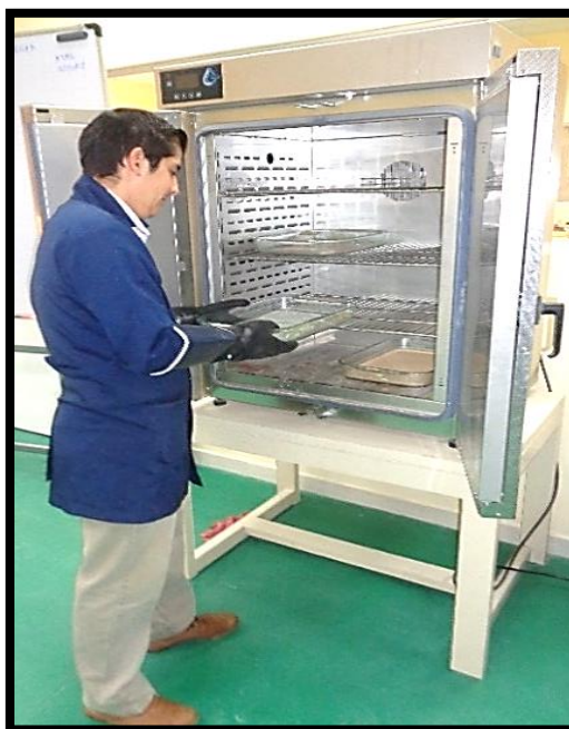
Foto N° 3. Secado de las muestras. Fuente: Espinosa, 2015
