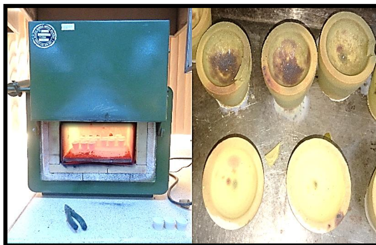
Foto N° 14. Horno de Copelación (i) y Perlas de Dore (d) Fuente: Espinosa, 2010
