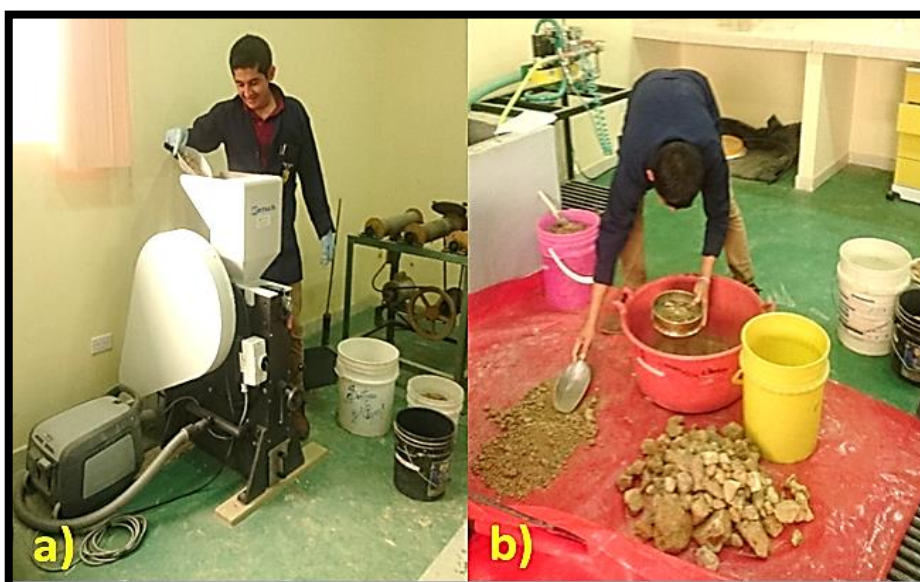
Foto N° 4. a) Trituración y b) 100% malla 10 Fuente: Espinosa, 2015
