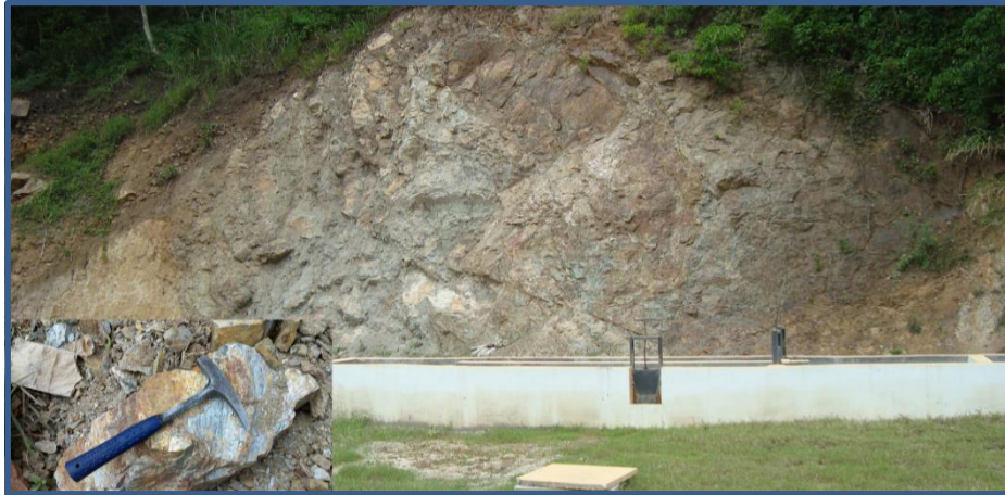
Figura 4. 1. Afloramiento de esquistos sericíticos metamórficos en el sector San Miguel al sureste del río Solanda (X: 683898 Y: 9535134). Fuente: Elizalde, 2015
