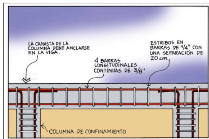
Figura 3.6.- Detalle de refuerzo en vigas de confinamiento.
