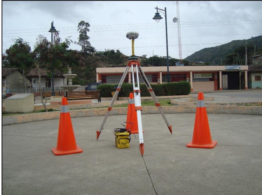
**Figura 5:** Equipo de GPS Diferencial, ubicado en la Estación Base El Tambo.
