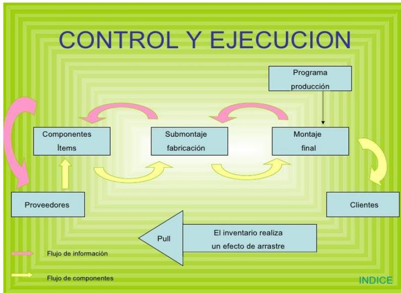
Figura 3: Propuesta del sistema de producción enfoque jit o pull
