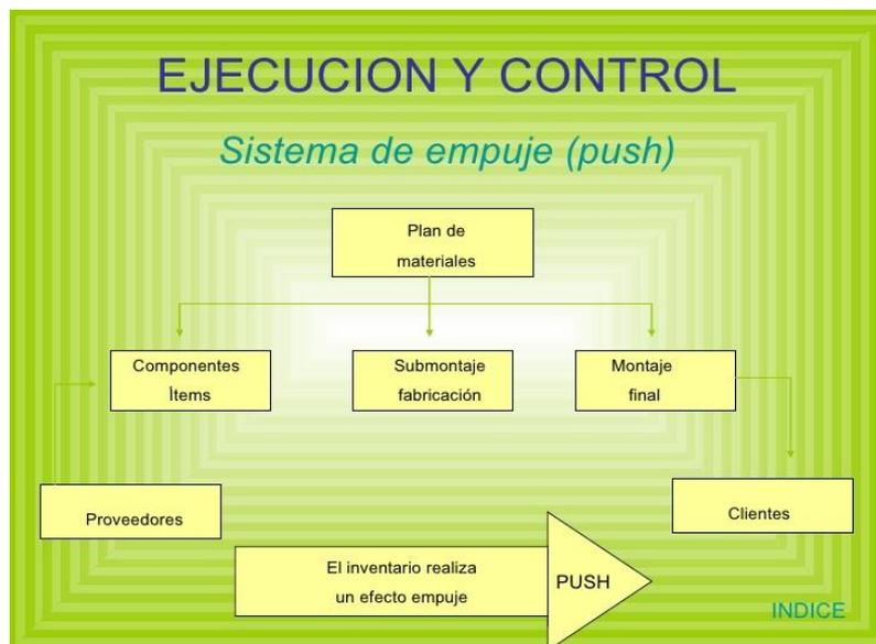
Figura 2: Sistema de producción modelo push
