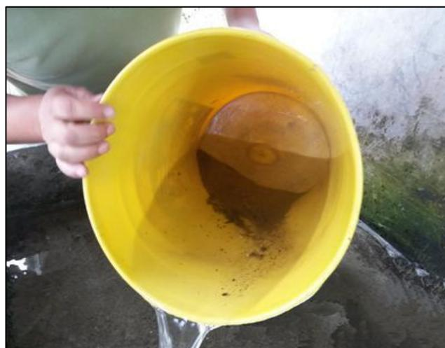
Figura 2. Sólidos sedimentados del agua del canal de riego.
