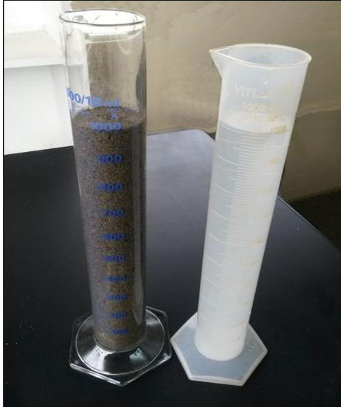
Figura 8. Columna de arena (1000ml) para calcular los espacios vacíos
