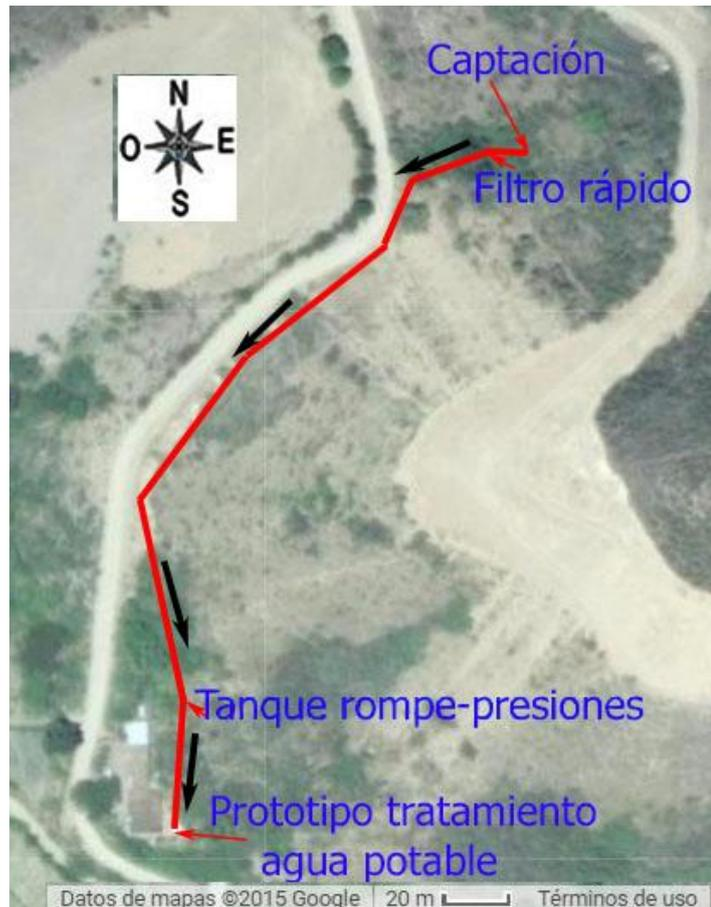
Figura 5 Ubicación de los diferentes componentes del tratamiento de agua
