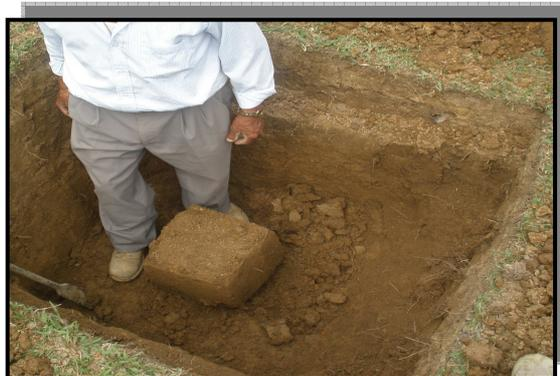
**Fig. 3.2.** Muestra inalterada de suelo
