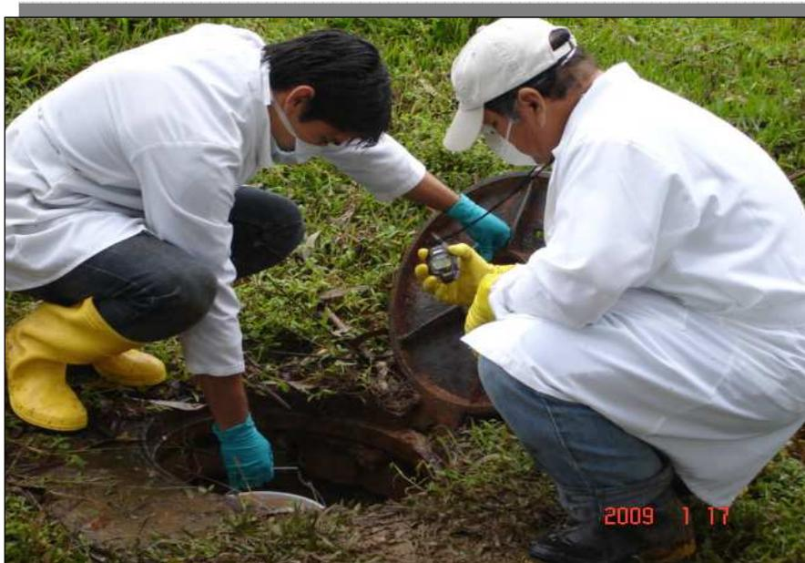
Fig.2.4. Aforo de las aguas residuales
