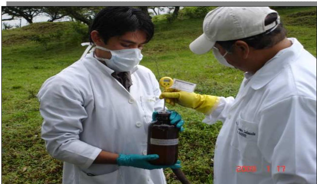
Fig.2.6. Medición de la temperatura en las muestras de agua residual
