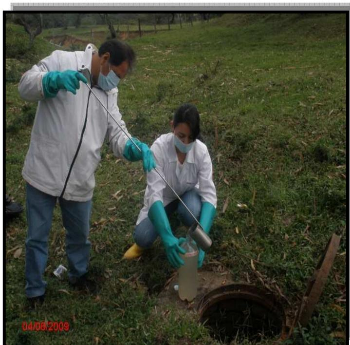
**Fig 2.2** Toma de muestras de ARU para ensayos físico-químicos
