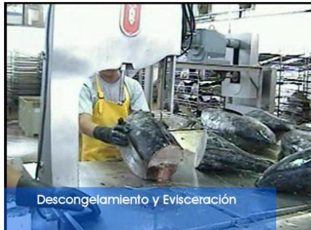
evisceradas, siempre las que tienen mayor peso en libras, es decir que pueden ser de 4-7 a +20 libras para posteriormente pasar al proceso de cocción, que se efectúa en autoclaves horizontales, a una temperatura de 102 ° C con una tolerancia entre (+2;-2) ° C, en un tiempo de 3 horas, lo cual depende del tamaño del atún.
