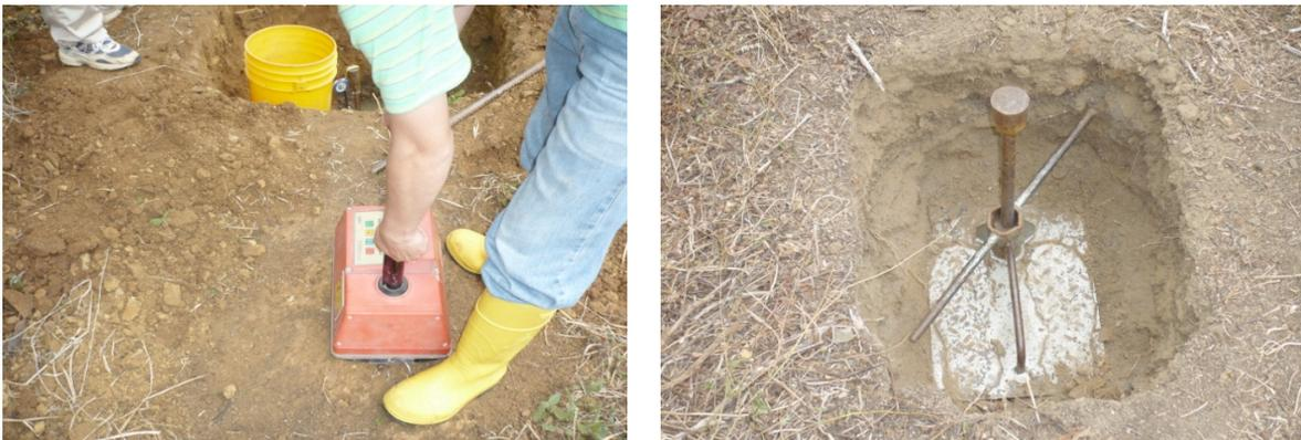
**Fig. 1-19 Medición con el densímetro nuclear**
