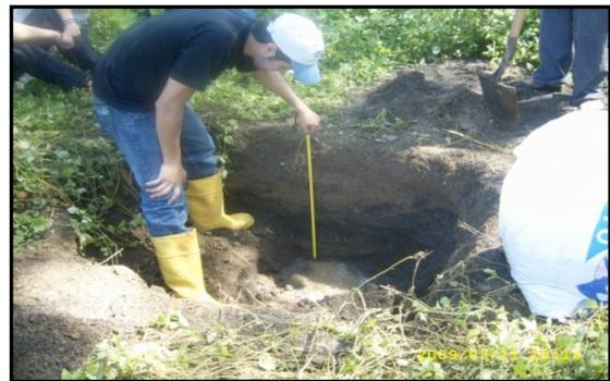
Para los ensayos determinados se utilizan aproximadamente 50kg de muestra en las cuales se van a realizar ensayos físicos como textura, clasificación, etc.
