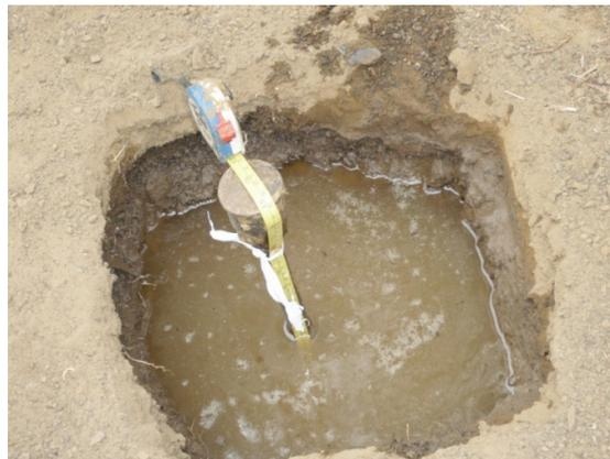
**Fig. 3-1 Velocidad de infiltración en una calicata**
