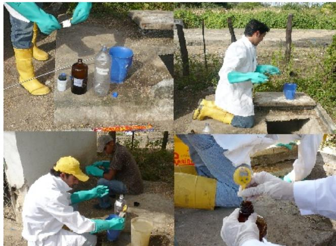
Fig. 2-3 Obtención de muestras y toma de temperatura in-situ
