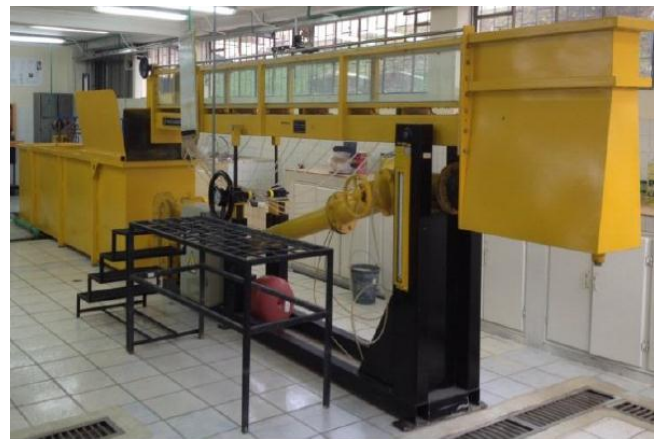
Fig. 12. Vista lateral del sistema de hidrogenación basado en vórtice gravitacional [28].
