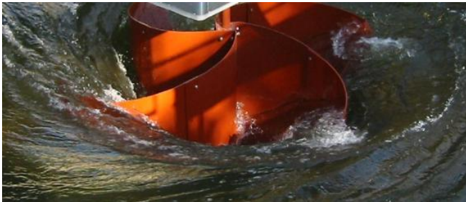
Fig. 18. Vista panorámica de una turbina de cuatro alabes en operación [31].
