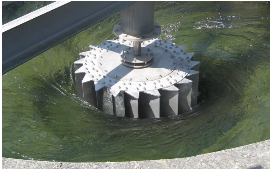
Figura 3.6. Vista panorámica de una turbina Zotlöterer en funcionamiento.
