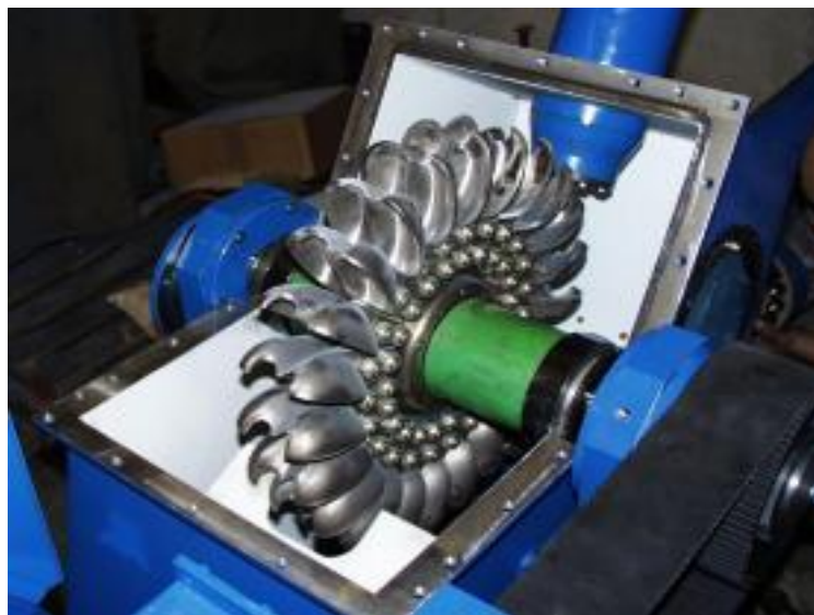
Figura 2.7. Microcentral hidroeléctrica equipada con una turbina Peltón
