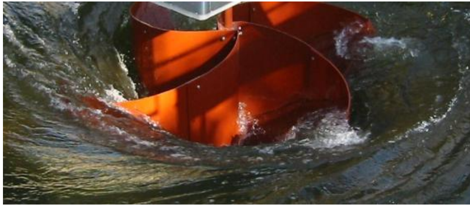
Figura 3.5. Vista panorámica de una turbina de cuatro alabes en operación
