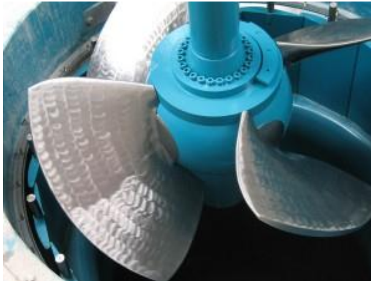
Figura 2.6. Microcentral hidroeléctrica equipada con una turbina Kaplan
