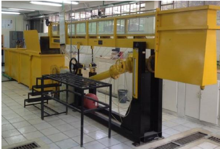
Figura 2.14. Vista lateral del sistema de hidrogenación basado en vórtice gravitacional.
