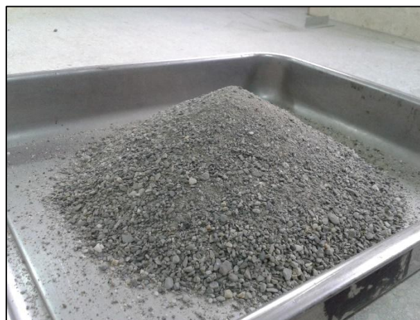
Figura 3. 2. Árido fino pasante de tamiz 4.75 mm (No. 4). Fuente: Los autores.
