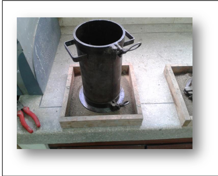
Figura Anexo 9. 10 Molde sobre cama de arena para evitar desniveles en el espécimen.
