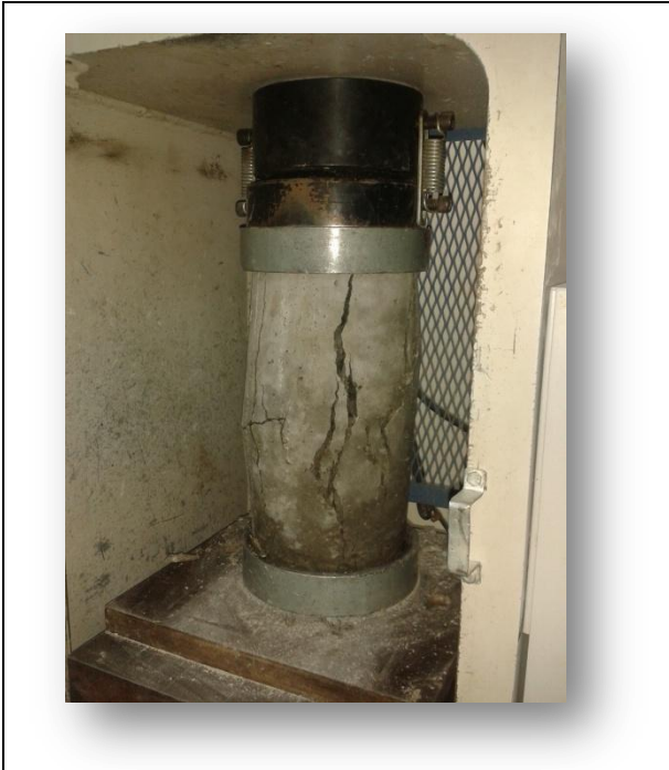
Figura Anexo 9. 14 Falla tipo 3.
