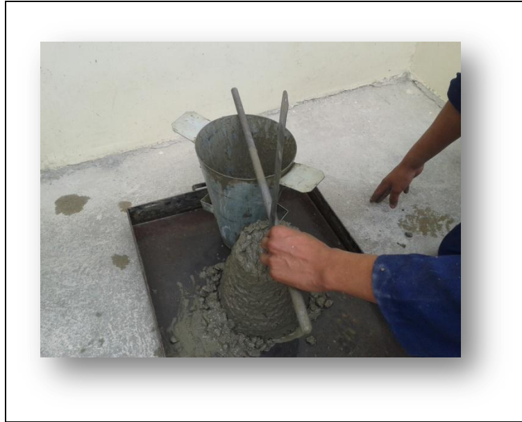
Figura Anexo 9. 9 Ensayo de asentamiento
