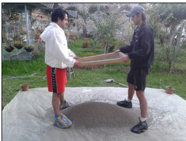
Figura 3. 1. Tamizado del árido fino – Tamiz abertura 4.75 mm (No.4) Fuente: Los autores.
