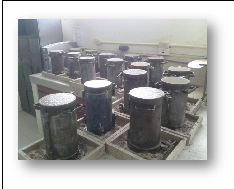
Figura Anexo 9. 11 Especímenes de concreto con y sin aditivo
