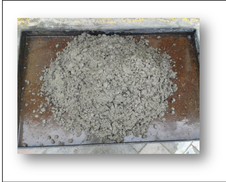
Figura Anexo 9. 8 Mezcla de concreto para hacer 8 especímenes cilíndricos
