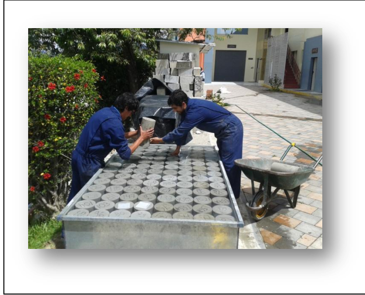
Figura Anexo 9. 12 Especímenes colocados en fuente de curado
