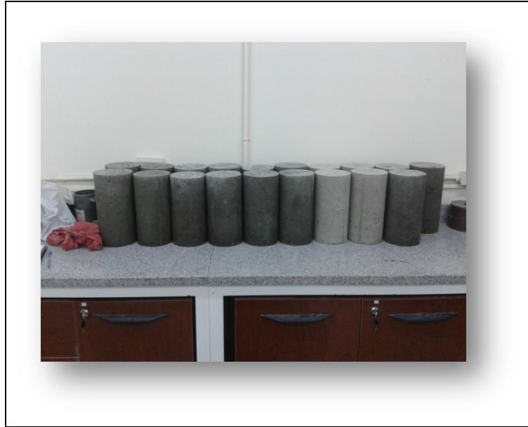
Figura Anexo 9. 13 Especímenes a ser ensayados a compresión
