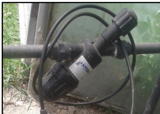
Figura 30. Filtro "Y" de red inoxidable de ¾". Fuente. El autor Elaboración. El autor, 2015.
