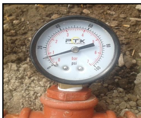
Figura 33. Manómetro con rango de presión de 0 a 10 Bar.
