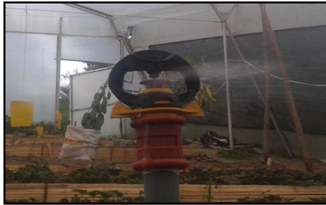
Figura 20. Microaspersor GyroNet turbo 200 l/h. Fuente. El autor. Elaboración. El autor, 2015.
