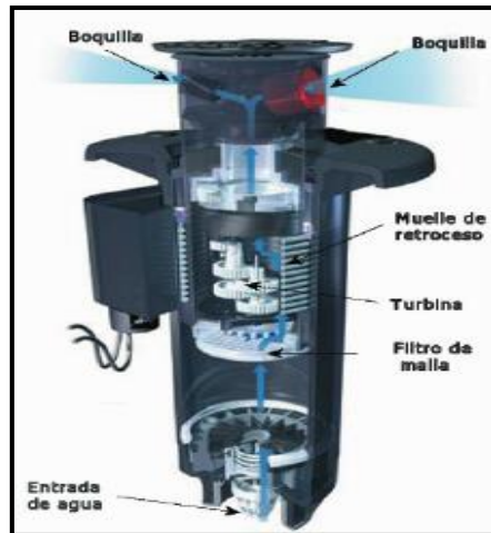
Figura 5. Aspersor de turbina. Fuente. Riego por aspersión en el medio urbano. (MSSI, 2012). Elaboración. El autor, 2015.
