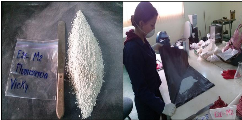
Ilustración 10. Homogenización del material por el método del Roleo. Fuente: Alvarado, 2015.
