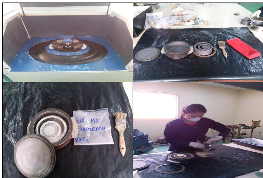
Ilustración 12. Pulverización de las muestras en el equipo RS-1. Fuente: Alvarado, 2015.
