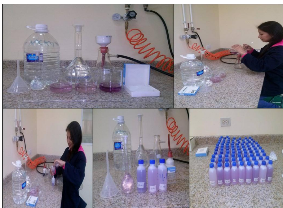
Ilustración 14. Digestión de las muestras utilizando Ácido Salicílico. Fuente: Alvarado, 2015.
