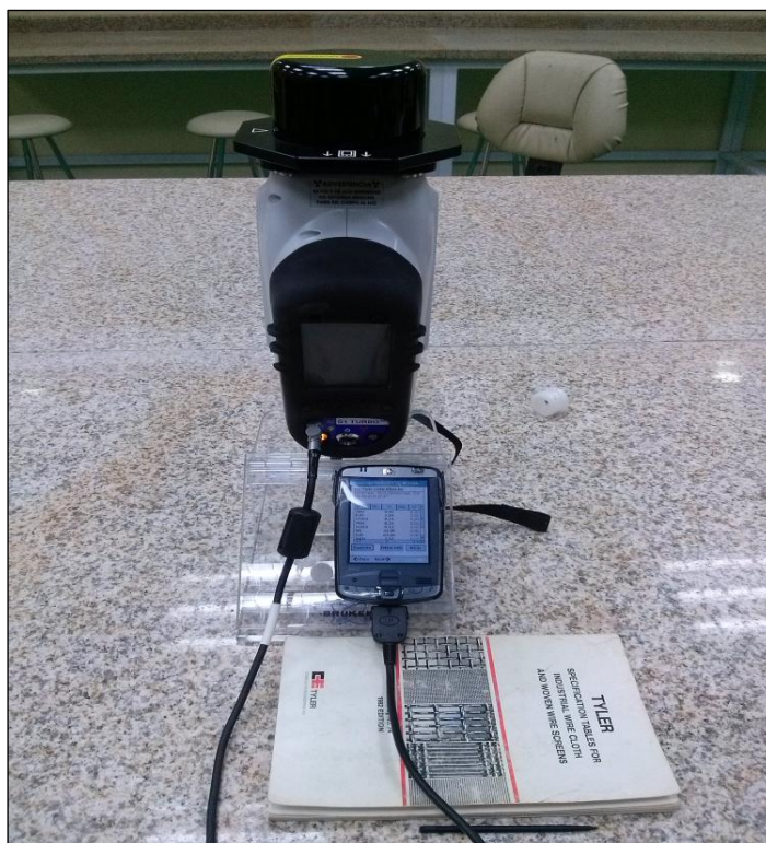
Ilustración 8. Analizador portátil BRUKER S1 TURBO SD Fuente: Alvarado, 2015.
