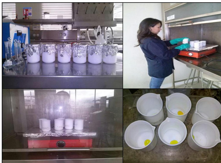
Ilustración 15. Digestión de las muestras utilizando Ácido Fluorhídrico. Fuente: Alvarado, 2015.
