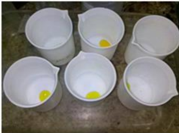
Figura 7. Digestión de la muestra con ácido fluorhídrico, Clorhídrico, nítrico concentrado y perclórico.
