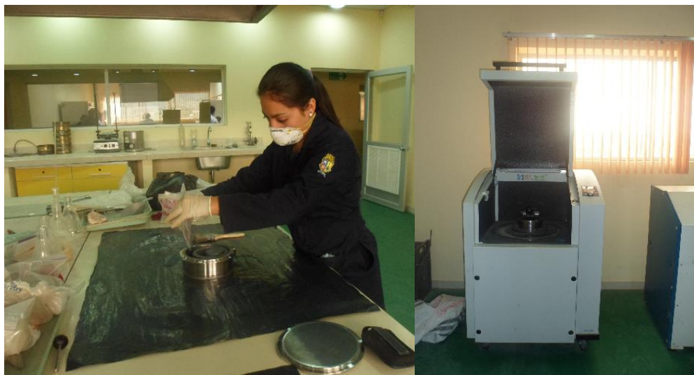
Figura 4. Pulverización de la muestra. Equipo Retsch 200. Fuente: Feijóo, 2015.
