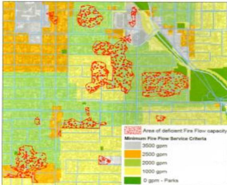
**Figura 7.** Requisitos mínimos de Caudal de Incendios y diferencias derivadas del modelo hidráulico y un análisis en un SIG.
