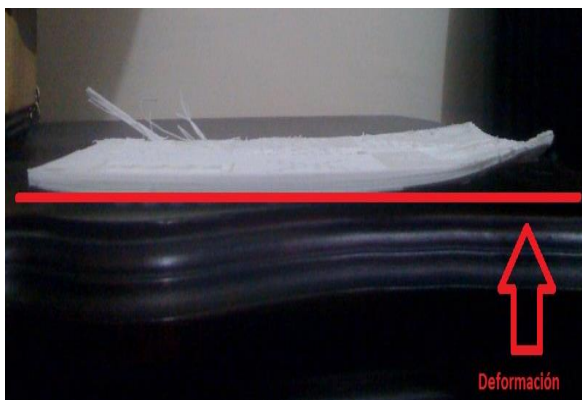
Fig. 21. Deformación de la impresión causada por problemas en la regulación térmica de la impresora 3D Makerbot Replicator 2X [Fotografía de los autores]
