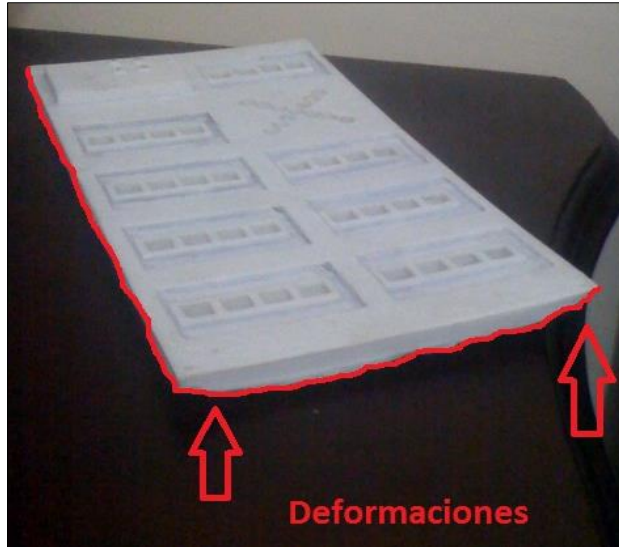
Figura 2. 9 Deformación de la impresión en la impresora 3D Cubex causada por la falta de adherencia a la placa de impresión
