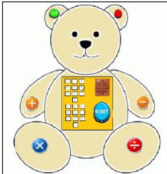
Figura 1. 3 Segunda opción de optimización del panel electrónico implementado para enseñanza de operaciones matemáticas básicas a niños con capacidades visuales especiales. Fuente: Autores.
