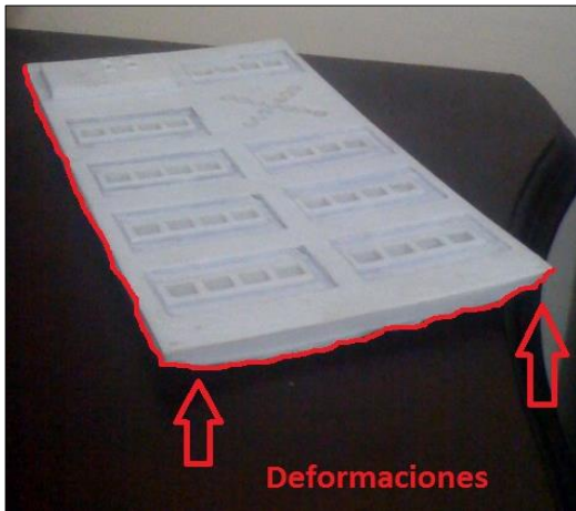
Fig. 24. Deformación de la impresión en la impresora 3D Cubex causada por la falta de adherencia a la placa de impresión [Fotografía de los autores]
