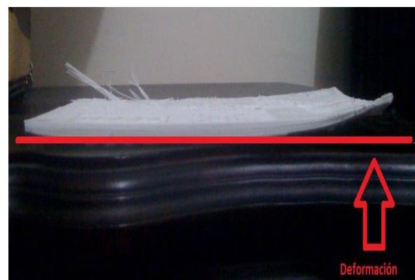
Figura 2. 6 Deformación de la impresión causada por problemas en la regulación térmica de la impresora 3D Makerbot Replicator 2X. Fuente: Autores
