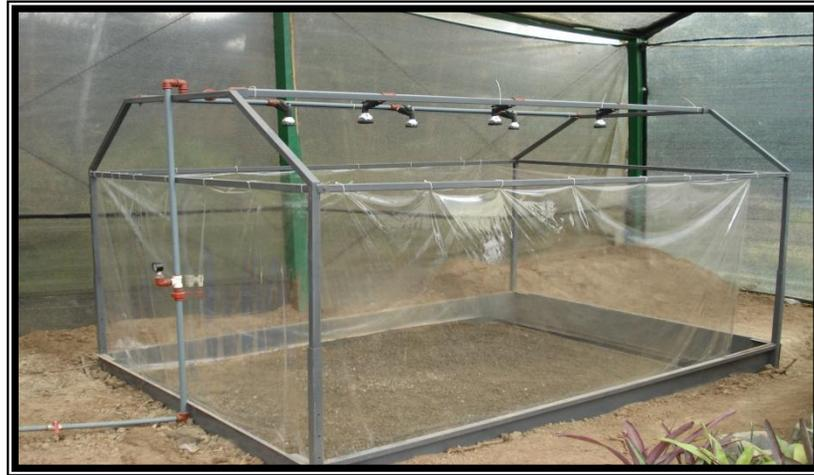
**Fig. 3.1** Simulador de lluvia tipo pulverizador
