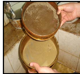
Figura 3.22 Protección del tamiz: a) Tamiz protector b) Lavado de muestra c) Lavado de muestra retenida de tamiz #40 d) Muestra retenida en tamiz #200.
