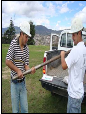
Fig. 3.3 Vista del tubo de pared delgada y el proceso de colocación en las barras de extensión Fuente: La autora
