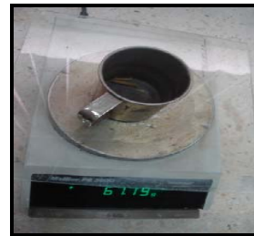
Figura 3.19 Contenido de Humedad: a) Peso Muestra Húmeda; b) Peso Muestra Seca. Fuente: La Autora.
