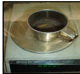
Figura 3.19 Contenido de Humedad: a) Peso Muestra Húmeda; b) Peso Muestra Seca. Fuente: La Autora.
