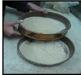
Figura 3.7 Tamizado de muestra. Fuente: La autora
