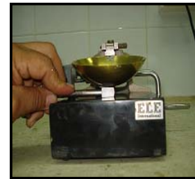
Figura 3.8 Calibración del equipo. a) Equipo necesario; b) Calibración de altura de caída de la copa.
