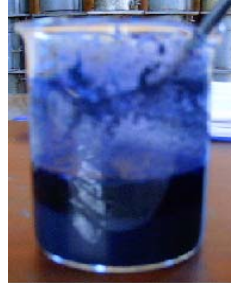
Figura 3.28 Absorción del catión AM sobre la superficie mineral Fuente: La autora
