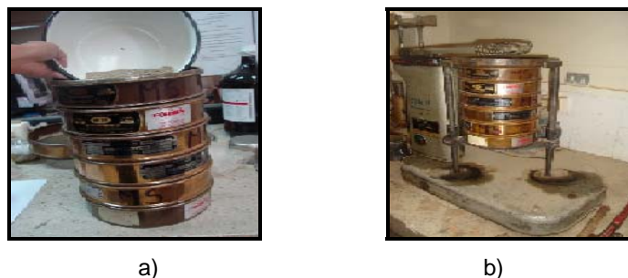
Figura 3.26 Tamizado de muestra: a) Muestra lista para tamizar b) Proceso de tamizado. Fuente: La autora
