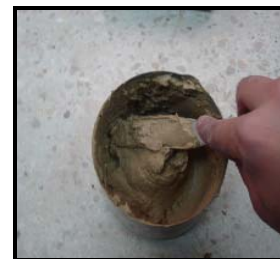
Figura 3.9 Preparación de la muestra: a) Selección de muestra; b) Mezclado de la muestra; c) Pasta homogénea.
