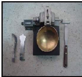
Figura 3.8 Calibración del equipo. a) Equipo necesario; b) Calibración de altura de caída de la copa.
