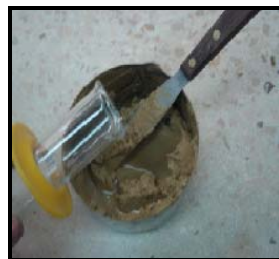
Figura 3.9 Preparación de la muestra: a) Selección de muestra; b) Mezclado de la muestra; c) Pasta homogénea.
