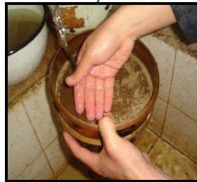
Figura 3.22 Protección del tamiz: a) Tamiz protector b) Lavado de muestra c) Lavado de muestra retenida de tamiz #40 d) Muestra retenida en tamiz #200.
