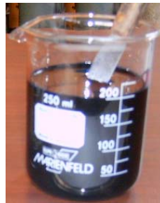
Figura 3.28 Mezclado del AM con el agua desionizada
